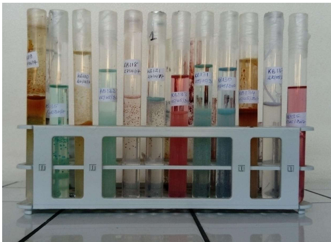
Figure A-8 : Synthèses par diffusion lente en milieu gel agar-agar à température ambiante avec la technique des tubes à essai
