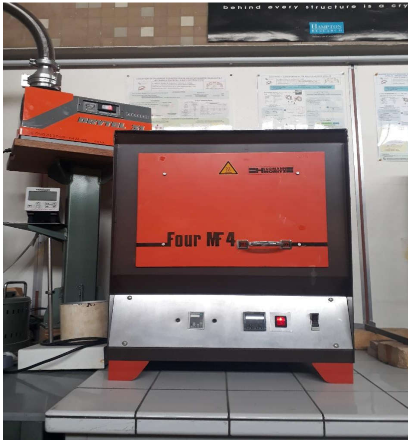
Figure A-9 : Four du Laboratoire CRM2 pour les synthèses par méthode hydrothermale
