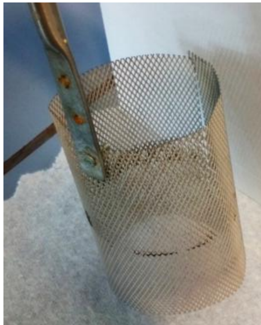
Figure 3-7 : Anode, grille en titane platiné
