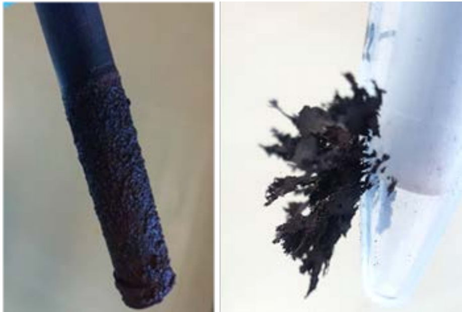
Figure 4-18: Images d'un dépôt de fer électrolytique sur une cathode en graphite (a : gauche) et d'un dépôt de fer adhérant à un aimant (b : droite).
