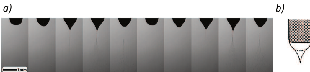
Figure 12 a) Images du mode cône-jet intermittent reproduites de l'article (Verdoold et al. , 2014). Le cycle représenté dure 25 ms. Liquide : éthanol. b) Représentation schématique de l'aspect du cône jet-intermittent observé avec un temps d'exposition plus long que le temps d'un cycle (reproduit de (Cloupeau et Prunet-Foch, 1994)).
