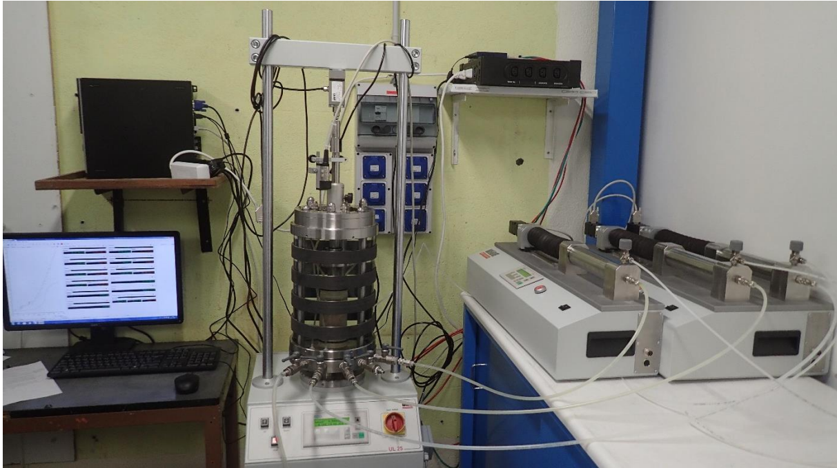
Figure 2.6 : Vue d'ensemble du dispositif triaxial (T50 et T100)
