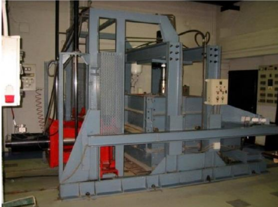
Figure 2.1 : Vue d'ensemble de la boîte de cisaillement B1000
