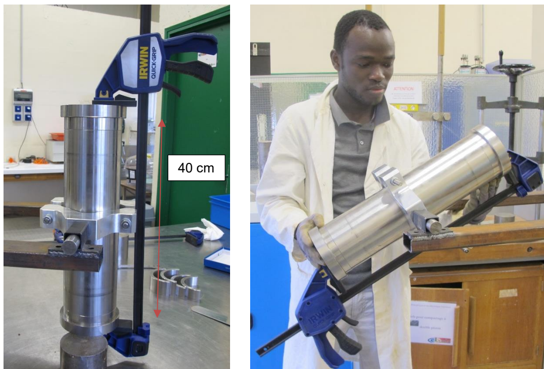
Figure 2.8 : Compactage par double-pistonnage des éprouvettes T100 de sol cohérent
