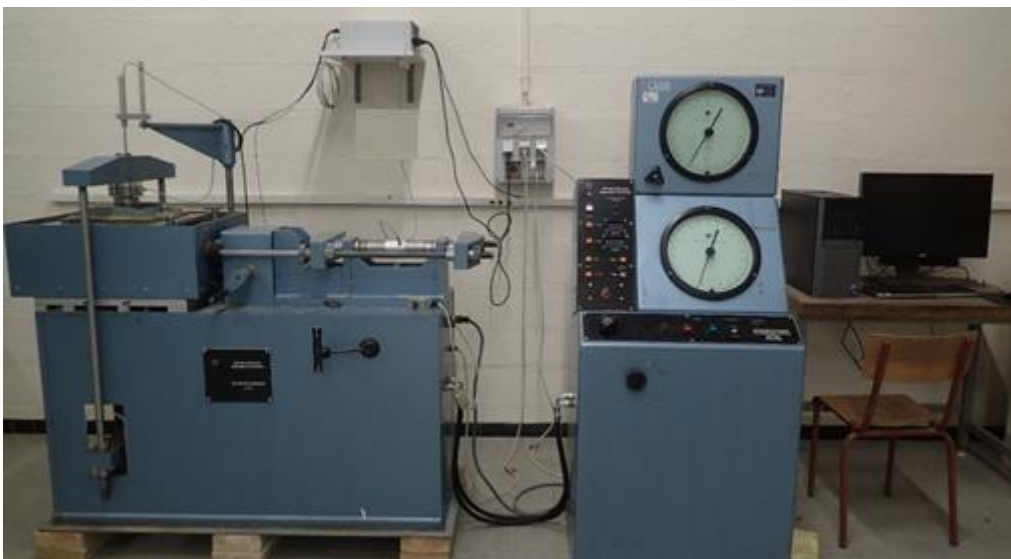
Figure 2.2 : Vue d'ensemble du dispositif de cisaillement B300
