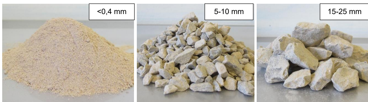
Figure 2.16 : Exemple de fractions granulométriques de LA : < 0,4 ; 5-10 et 15-25 mm
