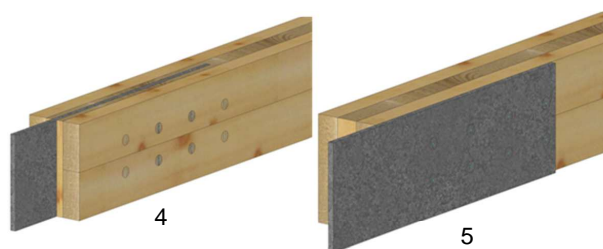
Figure 2.3. Schémas des différentes configurations d'assemblages mécaniques de type broche en bois lamellé croisé.
