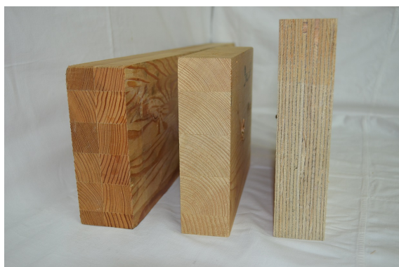
Fig. 2.3 Les différents produits bois pour les essais d'enfoncement. De gauche à droite : bois lamellé-feuilleté, bois lamellé-collé et lamibois.
