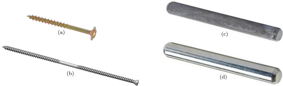
Fig. 1.5 Revêtements de protection sur les vis, les broches et les boulons. bi-chromaté (a), zinc lamellaire (b), galvanisation à chaud (c) et électrozingué (d).
