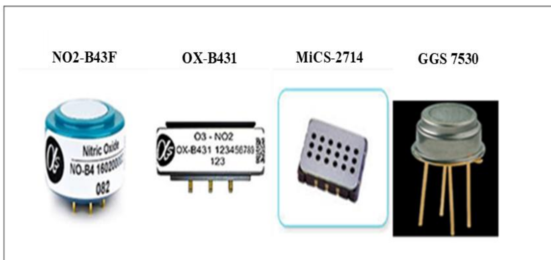
Figure II- 3 Capteurs choisis pour la mesure de dioxyde d'azote et d'ozone.
