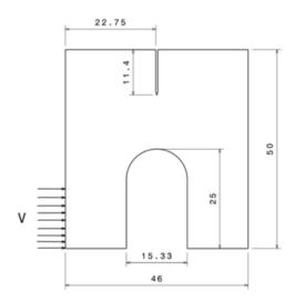
Figure 1: Géometrie de l'échantillon, avec des dimensions in mm. La vitesse d'impact V est appliquée sur une zone de  $16.5 \, mm$ .
