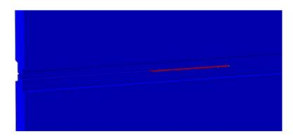
Figure 4: Bande d'endommagement à l'intérieur de la rainure.
