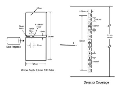
Figure 3: Echantillon avec rainure sous sollicitation d'impact non-symétrique et détecteurs IR pour mesure de temperature [17, 19].
