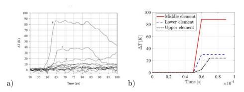
Figure 6: Variation de la température dans la région des détecteurs IR : (a) valeurs mesurées [19] et (b) valeurs numériques dans 3 éléments voisins correspondant aux trois détecteurs les plus proches de la fissure.
