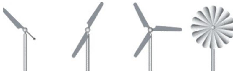
FIGURE 2.3 – Différents types d'éoliennes à axe horizontal
