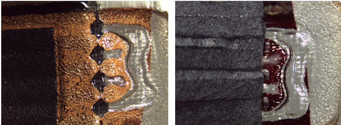
Figure 6.16. Images de l'AME utilisé avec la PTL+Au lors du Test E. a) Vue côté anode : le revêtement en or est resté collé sur les bords de la couche catalytique anodique. b) Vue côté cathode : l'or en contact avec la membrane a adopté une couleur violet foncée.
