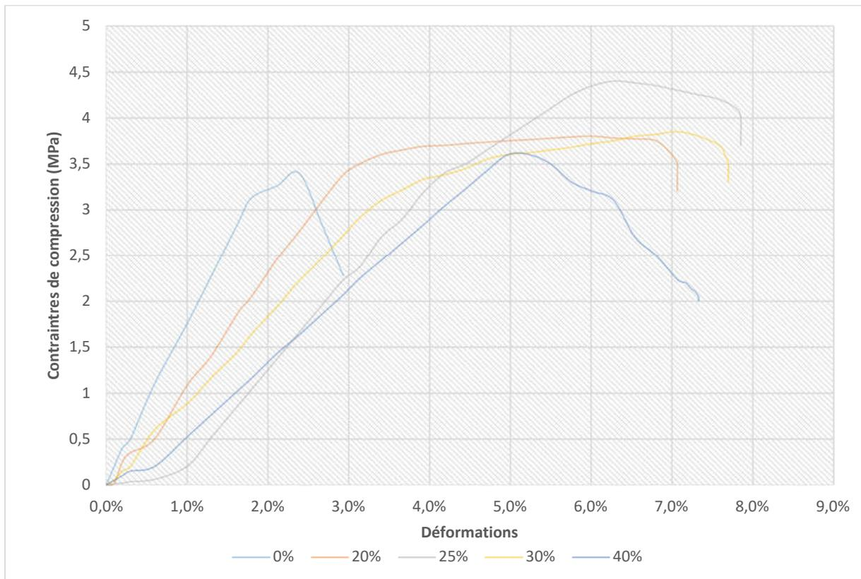
Figure 34 : Courbe contrainte-déformation en compression des éprouvettes prismatiques
