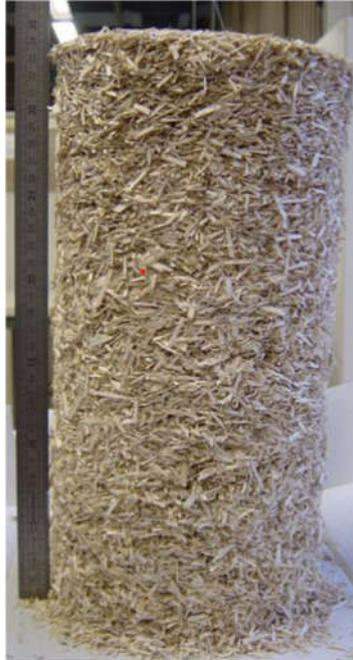
Figure 27 : Empilement des pailles dans une éprouvette cylindrique [124]
