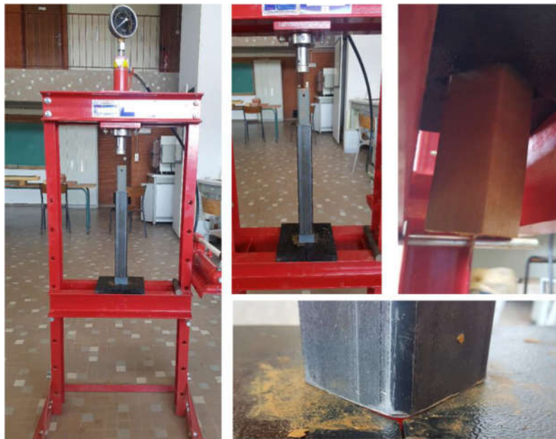
Figure 29 : Matériel pour la confection des échantillons
