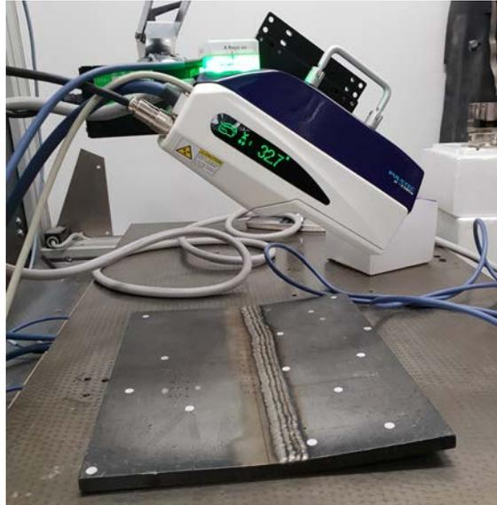
FIGURE 4.3 – Mesures expérimentales des contraintes résiduelles sur la plaque en acier 316L après soudage, avec l’analyseur portable Pulstec/ $\mu$ -X360s.
