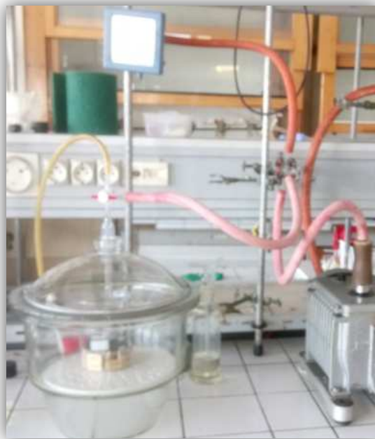
Figure 43: Dispositif d'imprégnation au LERMAB
