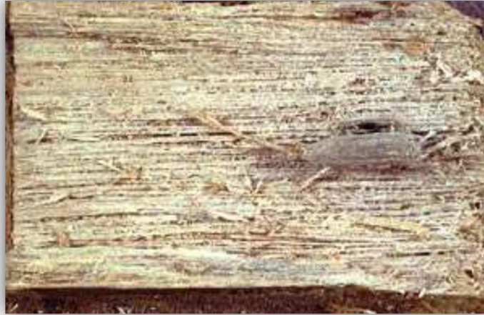
Figure 19: Observation macroscopique d'un bois d'apparence fibreuse due à l'attaque du bois par la pourriture blanche
