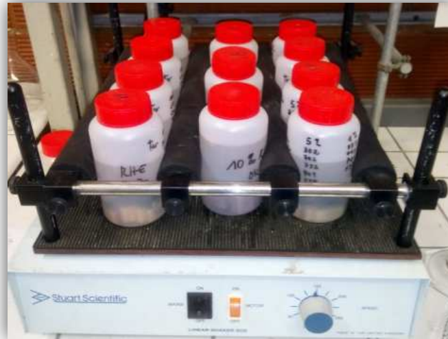
Figure 44: Dispositif du lessivage LERMAB
