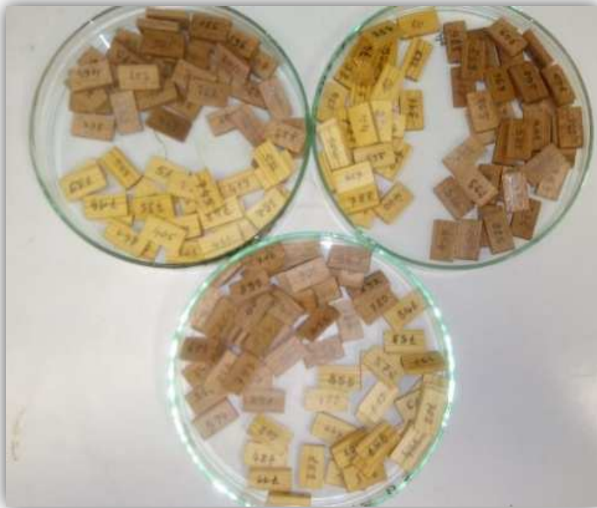
Figure 57: Les éprouvettes de hêtre et d'aubier de pin sylvestre imprégnées avant exposition aux différents agents de dégradation du bois
