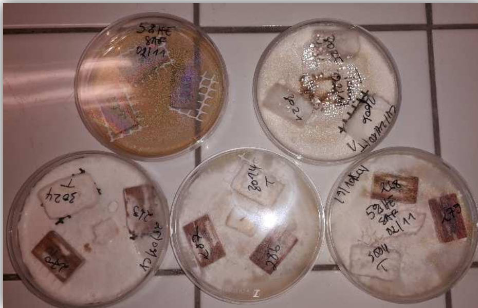
Figure 58: Exposition des éprouvettes traitées vis-à-vis de T. versicolor
