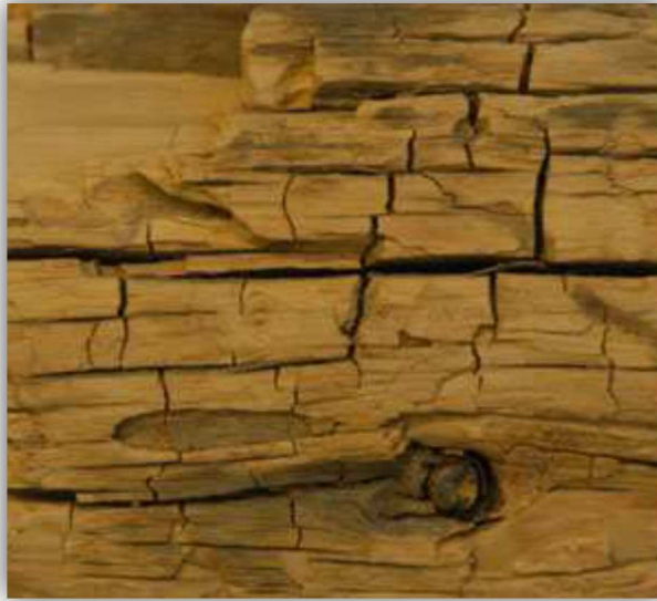
Figure 20: Observation macroscopique d'un bois altéré par la pourriture molle
