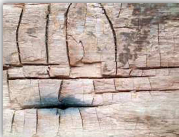
Figure 18: Observation macroscopique d'un bois d'apparence cubique due à l'attaque du bois par la pourriture brune
