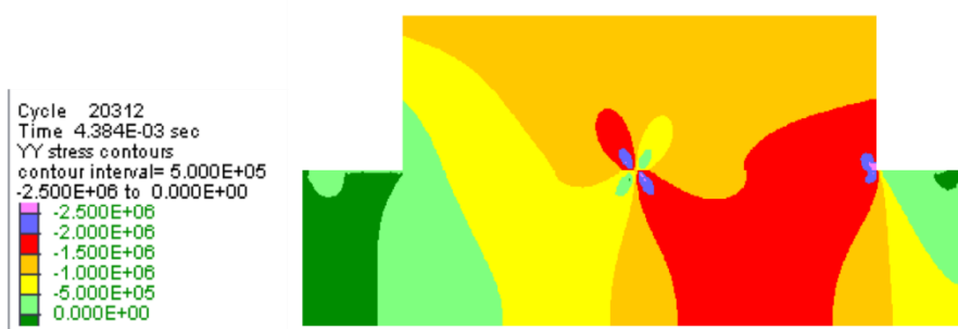
Figure 2.69 : Répartition des contraintes \sigma_{yy} durant l'essai de cisaillement, montrant la concentration des contraintes au niveau des ponts, et la rupture progressive de ceux-ci au cours des cycles.
