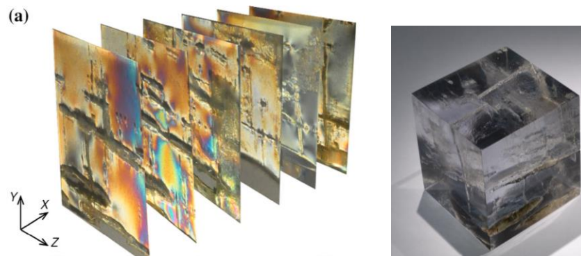
Figure 1.42 : (a) Visualisation de la distribution des contraintes dans des tranches des éprouvettes en matériau photoélastique, constituées par 3DP. Un exemple d'une éprouvette hétérogène (50 x 50 x 50 mm) est montré à droite de la figure (tirée de Ju et al., 2014).
