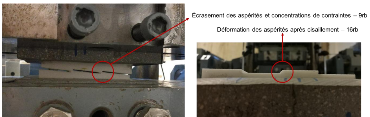
Figure 2.28 : État des aspérités ayant un angle de 90° environ au cours du cisaillement. Les aspérités sont écrasées et déformées sur leur coin sous l'effet de concentration des contraintes.
