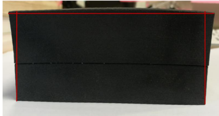
Figure 2.5 : Déformations externes de l'éprouvette de cisaillement construite par l'imprimante « Sinterit Lisa ». Les lignes rouges permettent de mettre en évidence visuellement les déformations de l'éprouvette.
