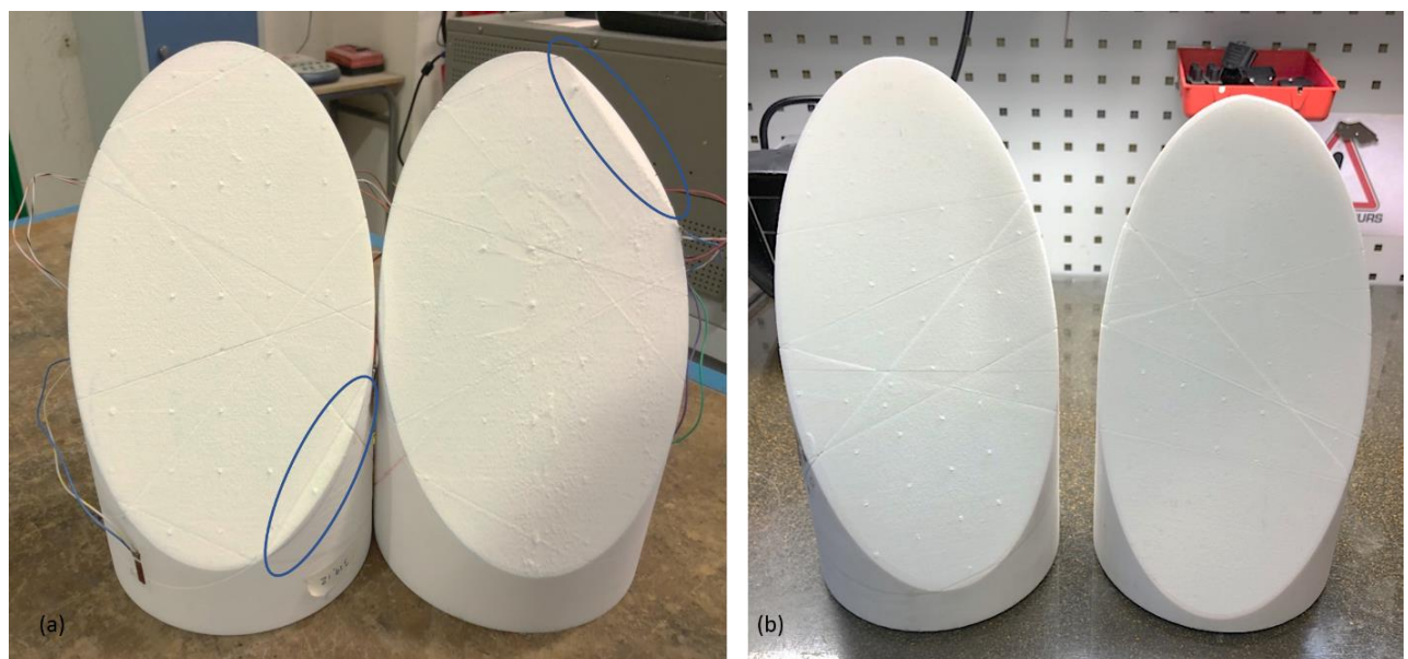
Figure 3.11 : Plan de rupture des éprouvettes (a) B-v24 et (b) B-v12. La rupture a lieu au niveau des ponts rocheux sans endommagement de la matrice. Dans (a), la rupture ne se fait pas sur un plan unique. Les ovales bleus montrent une discontinuité de la surface de glissement avec un bloc resté solidaire de la surface (demi-éprouvette de gauche).
