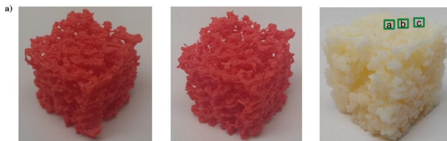
Figure 1.40 : Réseaux de fractures obtenues à partir de l'impression 3D par la technique FDM (tirée de Ishutov et al. , 2014).
