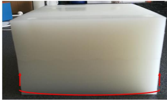
Figure 2.35 : Déformations externes sur les éprouvettes construites en PA12 par stratoconception.
