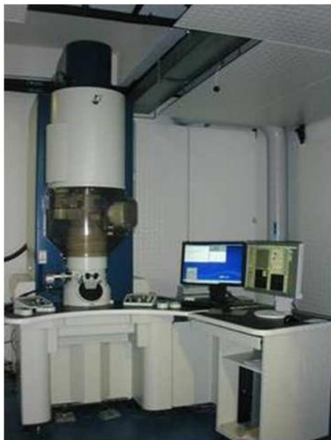
**Fig. II.5 : Vue générale du microscope en transmission à haute résolution JEOL ARM200F.**
