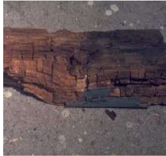
Figure 25: Aspect du bois attaqué par de la pourriture brune.
