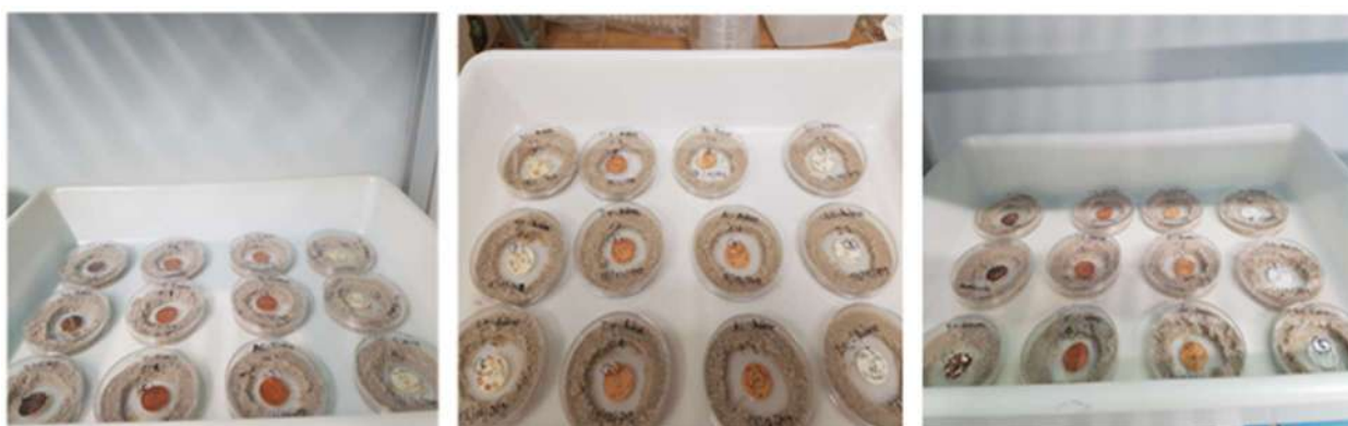
Figure 50: Essais termites sur papier Whatman.
