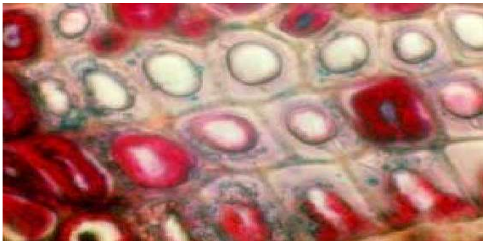
Figure 27: Vue au microscope de l'impact de la pourriture molle
