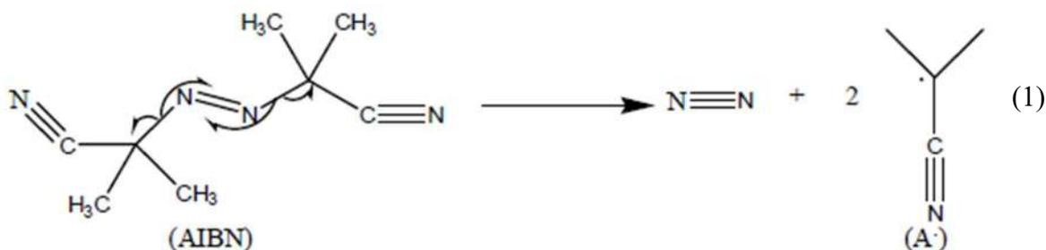
Au cours de la phase d'amorçage, sera produit un radical libre tertiaire stabilisé par le groupement nitrile. Ce radical va alors réagir avec le linoléate de méthyl pour transformer l'espèce radicalaire sur ce dernier (réaction 2).
