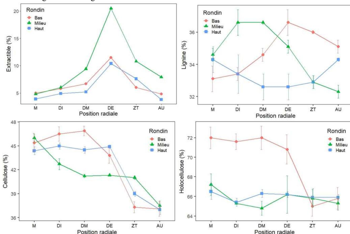
**Figure 51:** Variabilité intra-arbre de la composition chimique (moyenne trois essais  $\pm$  écart-type) des différents compartiments en bois sur la section transversale à partir des rondins : M, DI, DM, DE, TZ, AU
