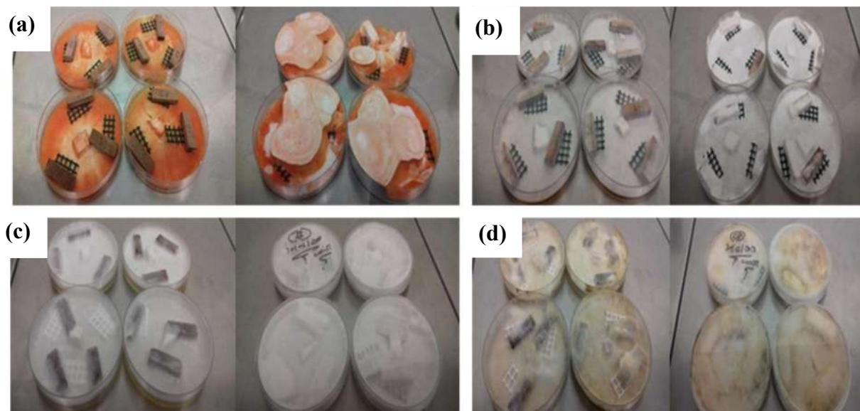
**Figure 58:** (a) blocs extraits et non extraits exposés à *PS* ; (b) blocs extraits et non extraits exposés à *TV* ; (c) blocs extraits et non extraits exposés à *RP*; (d) blocs extraits et non extraits exposés à *CP*.
