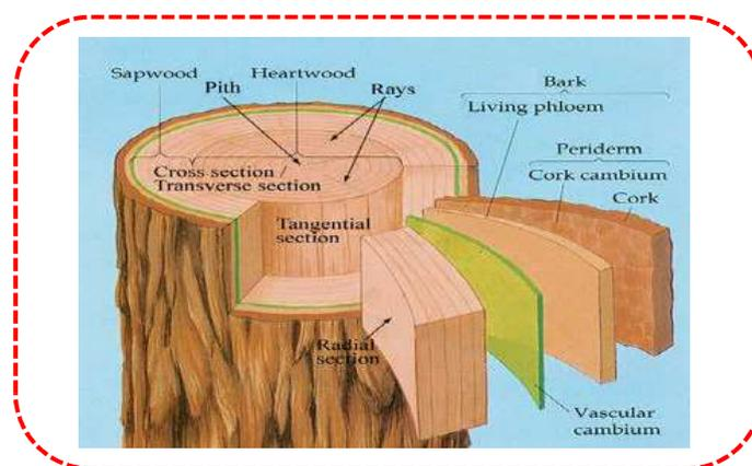
**Figure 1:** Schéma de coupe transversale d'un tronc d'arbre. Copyright University of Cambridge, DoITPoMS 2019.
