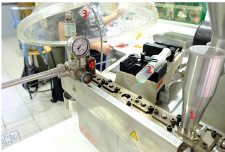
Figure III.30: Montage du procédé d'extrusion des nanocomposites: 1) arrivée du polypropylène, 2) système de pousse-seringue, 3) aspiration des vapeurs, 4) système de pompe à vide.
