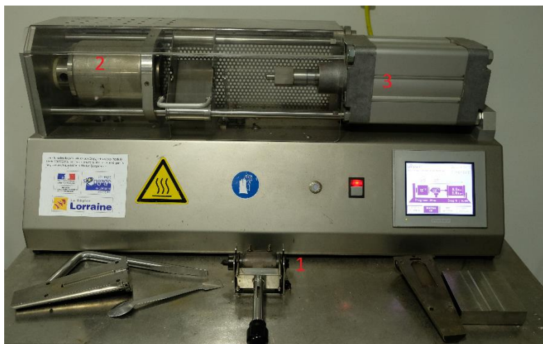
Figure II.5: Système d'injection pour la mise en forme des échantillons polymère avec en : 1) cellule chauffante, 2) moule et système de chauffage du moule et 3) vérin sous air comprimé.
