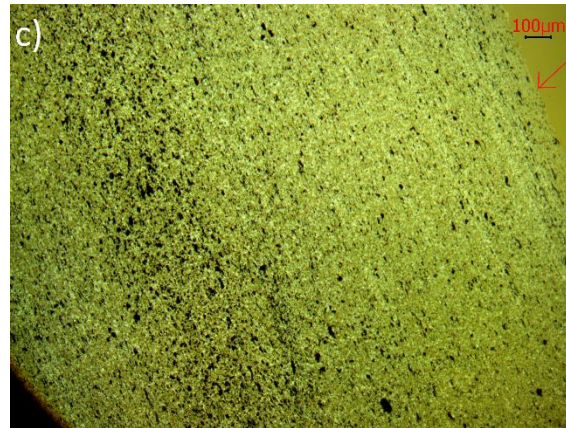
Figure III.36: Observation au microscope optique en transmission des nanocomposites chargés KNG 180 traité à a) 1 %m, b) 3 %m, c) 5 %m. La flèche rouge indique la surface de la plaque injectée.
