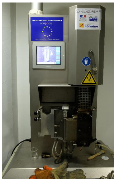
Figure II.4: Micro 12 cc injection Moulding Machine de la compagnie DSM Xplore employé pour l'injection des matrices réticulées.
