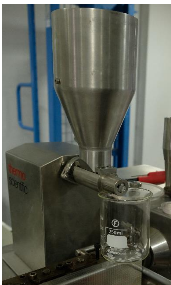
Figure II.1: Trémie d'alimentation permettant le contrôle du débit massique entrant du PP-g-MAH.
