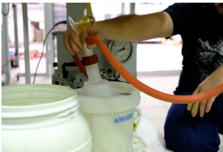
Figure III.31: Piège sous azote du mésitylène gazeux extrait du mélange extrudé.
