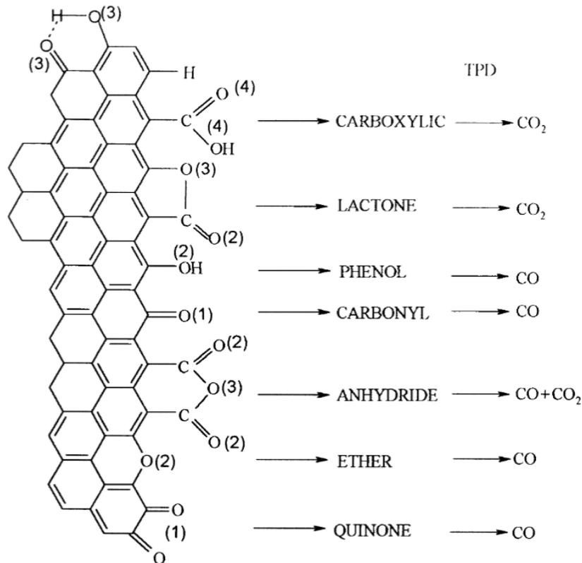
Figure I.33: les différentes fonctions oxygénées pouvant être retrouvées sur une nano-charge de graphite/graphène et les gaz d'émissions associés [291]
