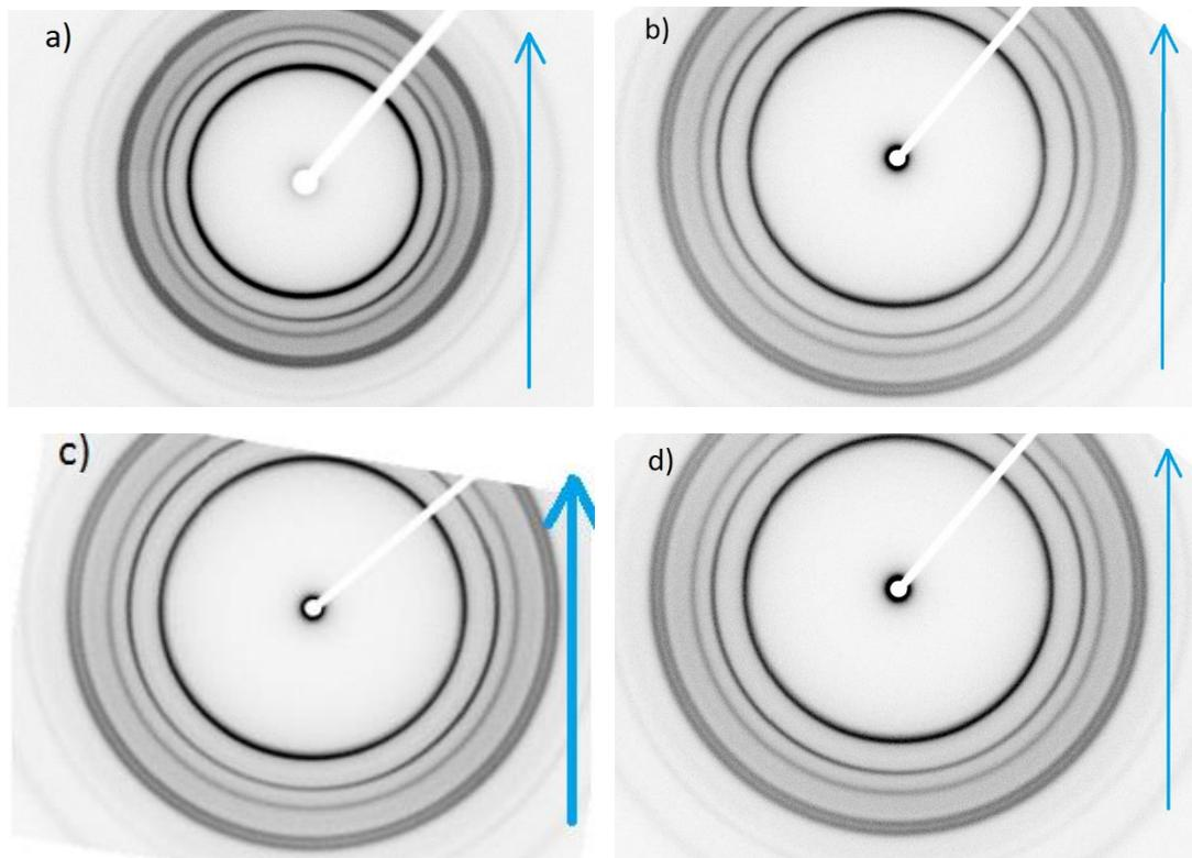
Figure III.74: cliché WAXS 2D des différentes éprouvettes pré déformées avec en a)  $\epsilon_{33}=0$ , b)  $\epsilon_{33}=0,04$ , c)  $\epsilon_{33}=0,08$ , d)  $\epsilon_{33}=0,15$ , du nanocomposite chargé à 1% de graphite KNG 180. Les flèches indiquent le sens de traction appliqué.
