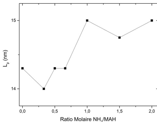
Figure II.11: Evolution de la longue période des matériaux CA 100 + THF 100 en fonction du ratio molaire NH<sub>2</sub>:MAH.
