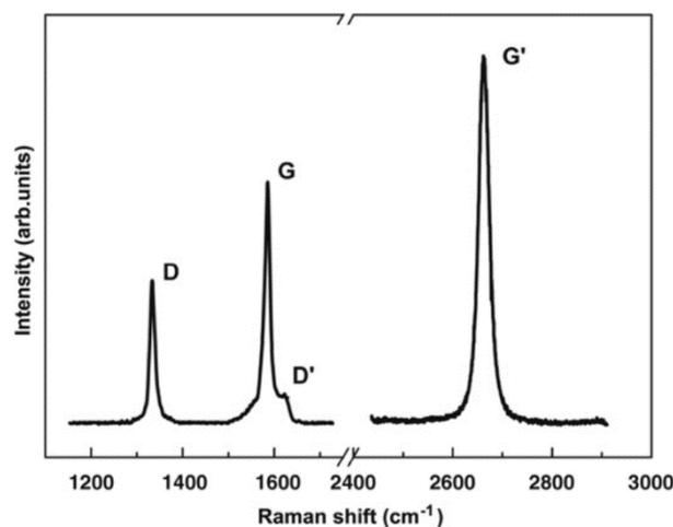
Figure I.32: Spectre Raman d'un bord Feuille de graphène [285].
