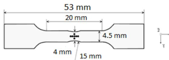
Figure I.61 : Dimensions des éprouvettes pour VidéoTraction™
