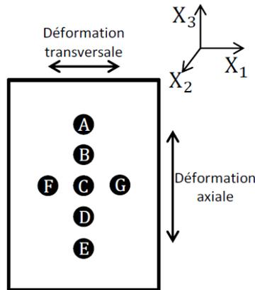
Figure 1.63 : Motif de tache pour traction uniaxiale
