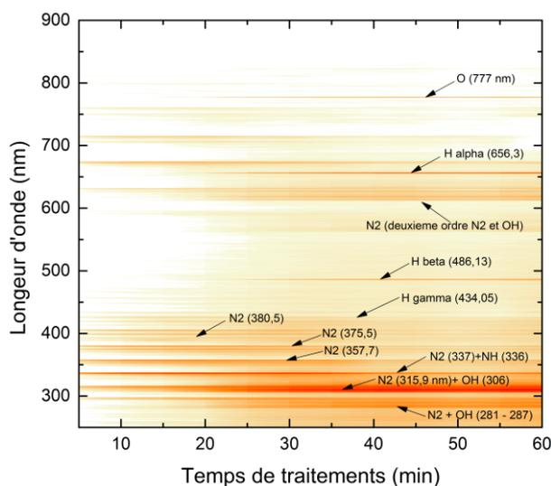
Figure III.8: Evolution du spectre d'émission intégré du plasma au fur et à mesure du traitement.
