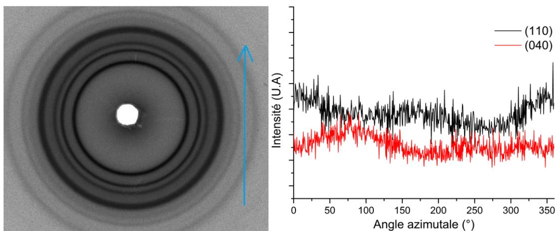
Figure A.19 : Cliché WAXS 2D du CA 100 THF 100 1:2 et profile azimuthale des plans de diffraction (110) et (040) du polypropylène.
