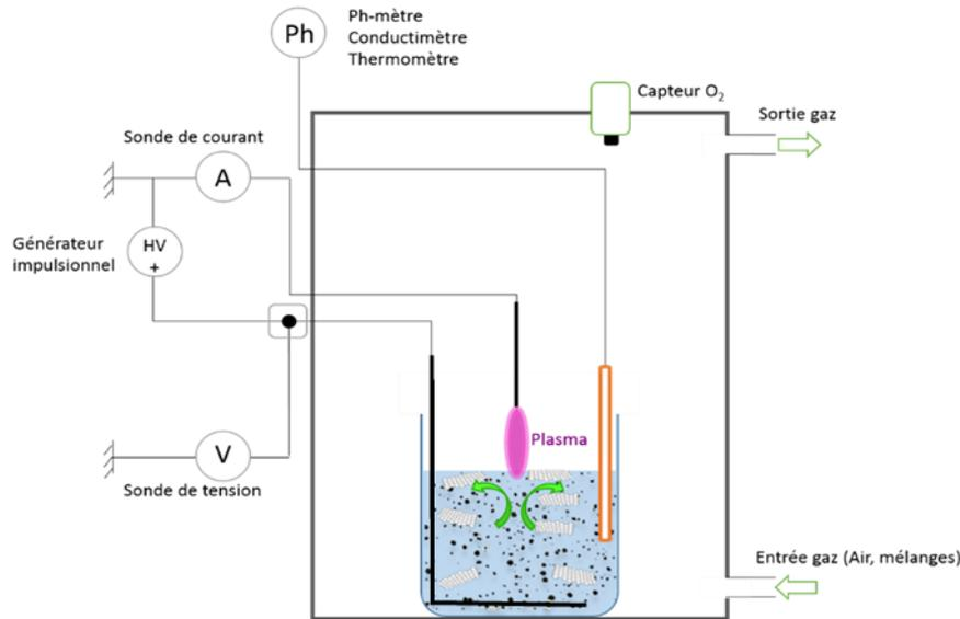
Figure III.1: Montage expérimental pour le traitement des nano-charges de carbones par plasma en phase liquide
