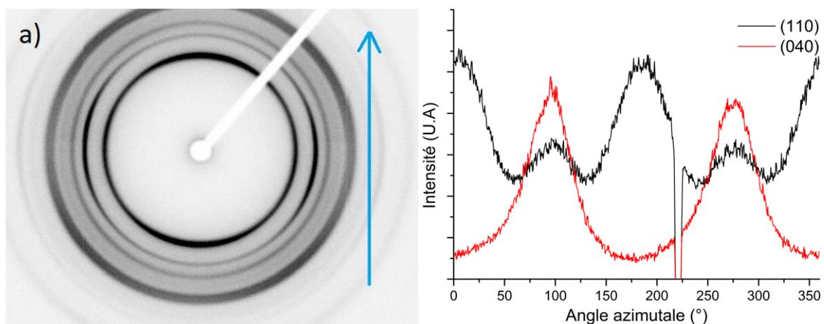
Figure A.28: Cliché WAXS 2D du CA 100 T3000 1:1 et profile azimutale des plans de diffraction (110) et (040) du polypropylène.
