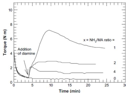
Figure I.10 : Evolution du couple appliqué lors de l'ajout de la diamine pour différents ratios NH<sub>2</sub>:MAH, extrait de Cui *et al.*, [75].
