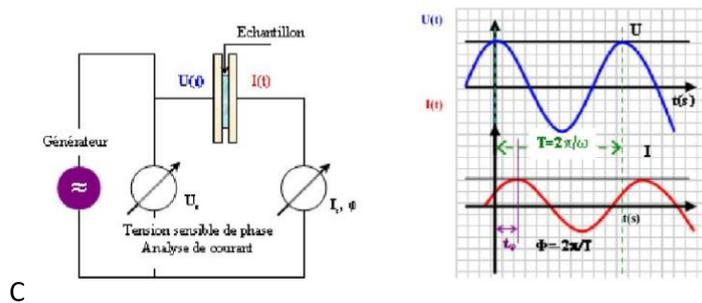
Figure 1: Principe de la mesure en analyse diélectrique [464]
