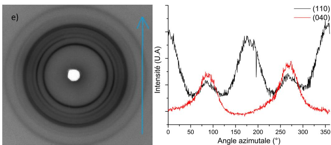
Figure A.48 : Cliché WAXS 2D du CA 100 THF 100 1:1 déformé à  $\epsilon_{33}=1,2$  et profile azimuthale des plans de diffraction (110) et (040) du polypropylène.
