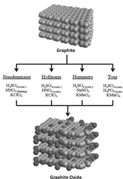
Figure 1.24: Les différents chemins de production du graphite oxydé [221]
