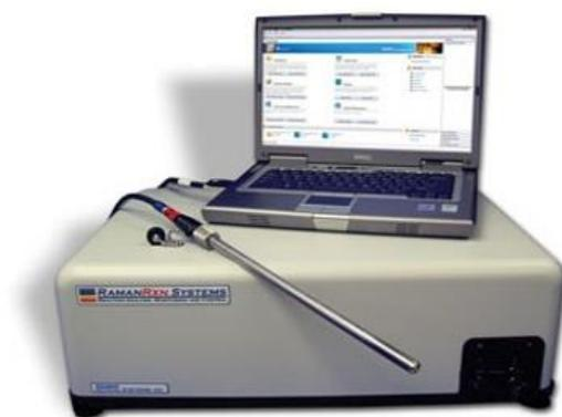
Figure I.58: Spectromètre Raman RXN1-785 nm de la marque Kaiser Optical Systems.
