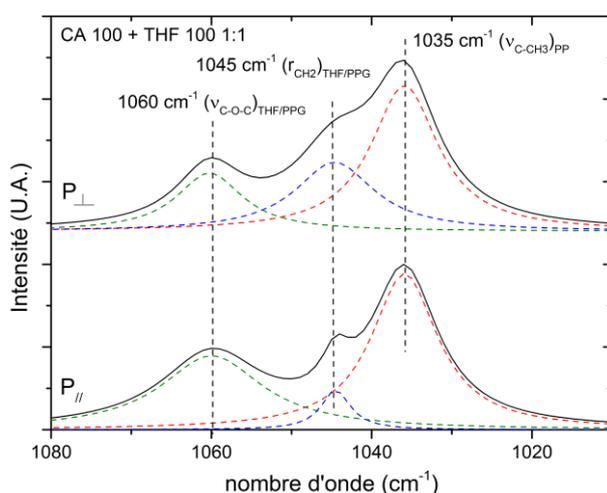
Figure II.25: Évolutions des bandes vibrationnelles associées à la THF et au PPG d'un échantillon déformé à  $\epsilon_{33} = 1,5$  suivant que la mesure a été réalisée dans une polarisation parallèle ( $P_{//}$ ), ou perpendiculaire au sens de traction ( $P_{\perp}$ ). Les spectres sont normalisés par l'intensité de la bande à  $1035 \text{ cm}^{-1}$  du PP.
