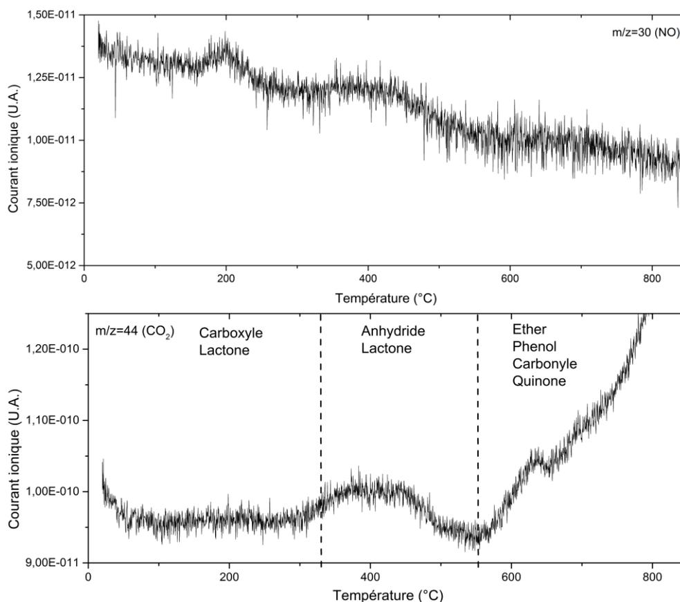
Figure III.28: Evolution de la perte de masse et du spectre de masse  $m/z = 28$  (CO), 30 (NO) et 44 (CO<sub>2</sub>) de la nano-charge KNG 180 traitée par plasma et greffée diamine lors des essais ATG sous hélium réalisé à 5 °C.min<sup>-1</sup>.
