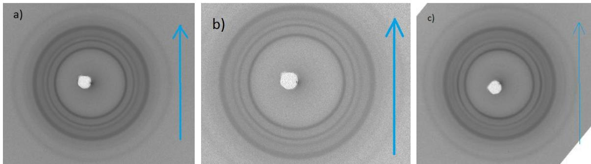
Figure III.33: Cliché WAXS 2D des nanocomposites chargés KNG 180 traité à a) 1, b) 3, c) 5 %m. Le sens d'injection des échantillons est indiqué par une flèche bleue.
