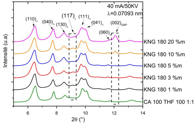
Figure III.42: Diffractogramme DRX des différents nanocomposites chargés KNG 180.
