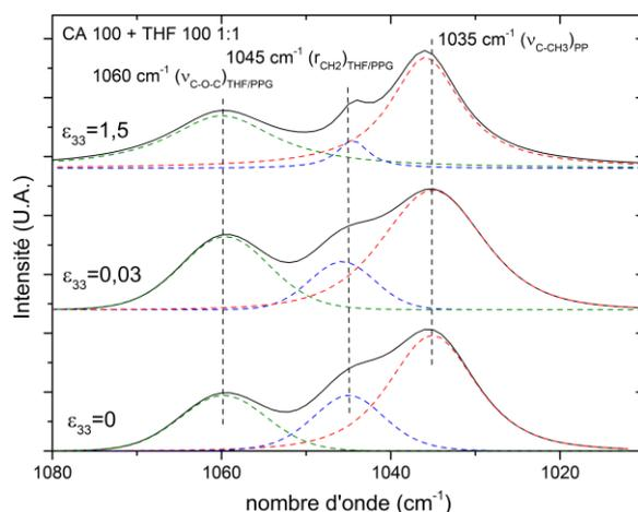
Figure II.24 : Évolutions des bandes vibrationnelles associées au THF et au PPG lors de la déformation vraie, à l'état initial ( $\epsilon_{33} = 0$ ), en fin de déformation viscoélastique ( $\epsilon_{33} = 0,03$ ) et lors du durcissement structural ( $\epsilon_{33} = 1,5$ ). Les mesures sont réalisées suivant une polarisation dans le sens de la traction, les spectres sont normalisés par l'intensité de la bande à  $1035 \text{ cm}^{-1}$  du PP.
