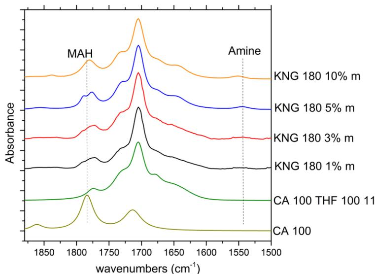
Figure III.39: Spectre infrarouge des différents nanocomposites chargés KNG 180
