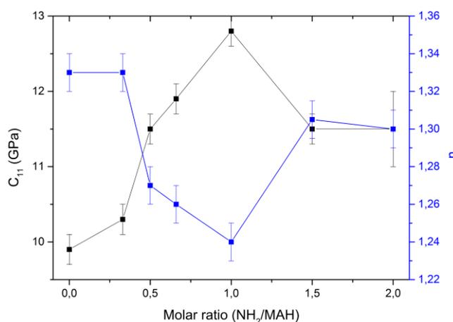
Figure II.15: évolution de la constante élastiques  $C_{11}$  et de l'indice optique avec le ratio molaire  $NH_2:MAH$  pour la gamme de matériaux CA 100 + THF 100
