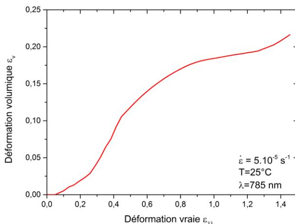
Figure II.47: Évolution de la déformation volumique du CA 100 + T3000 1:1 lors de la déformation estimée par spectroscopie Raman *in situ*.
