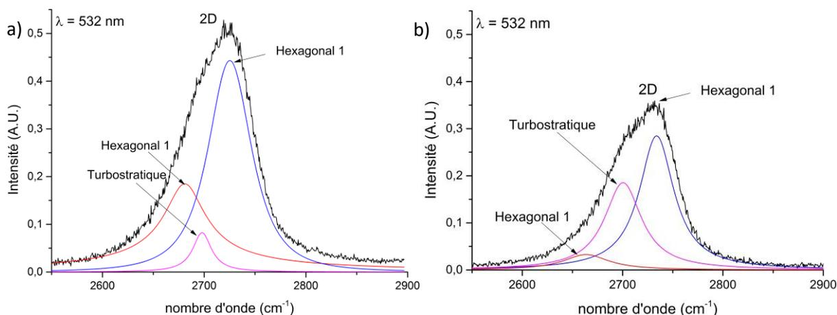
Figure III.18: Spectres Raman normalisés de la bande 2D, a) de la nano-charge KNG 180, et b) de la nano-charge traitée par plasma.
