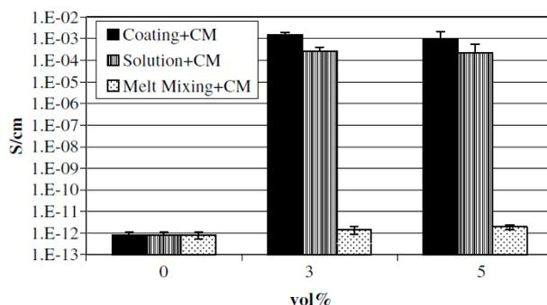
Figure 1.49: Evolution de la conductivité électrique au sein de nanocomposites PP/GNP suivant la méthode d'élaboration utilisée [335].
