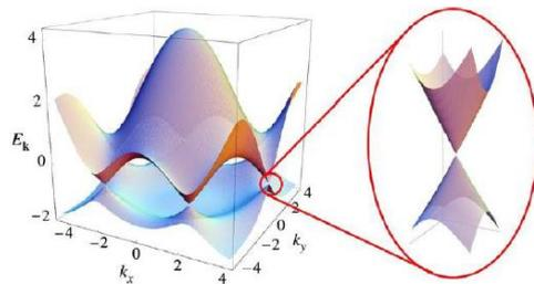
Figure I.22: Représentation de la structure de bande du graphène [176].
