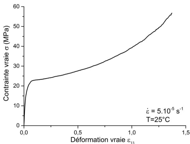
Figure II.39: comportement mécanique vrai CA 100 + T3000 1:1 en traction uniaxiale.
