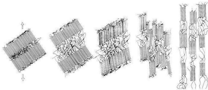
Figure I.15: Déformation d'un polymère semi-cristallin et formation d'une structure fibrillaire suivant le modèle de Schultz [124].
