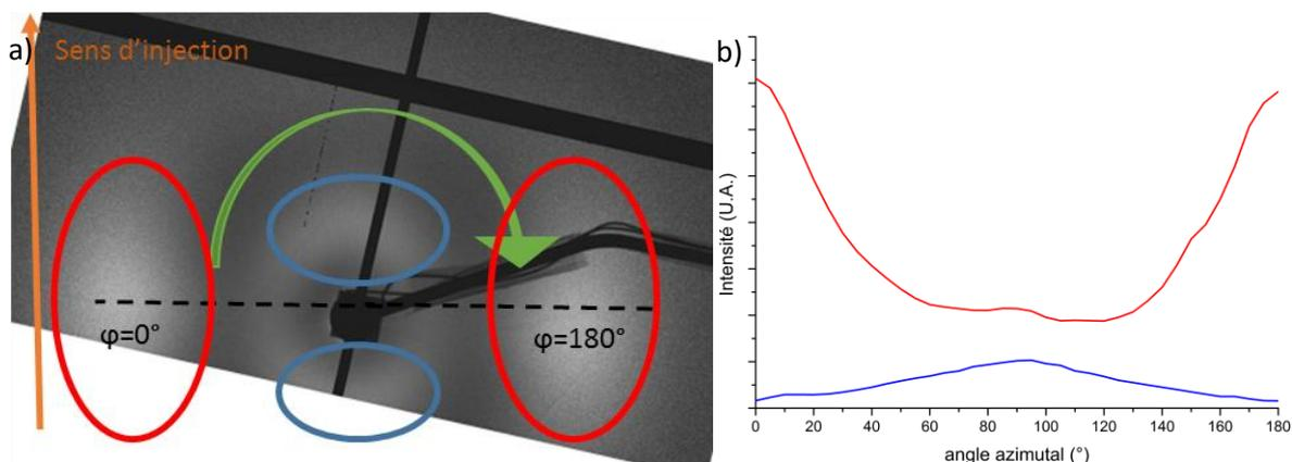
Figure II.13: A) cliché SAXS du matériau G 3015 1:1. Les paires de halos de diffusion sont indiquées en bleu et en rouge. La flèche orange indique la direction d'injection, la verte le sens de l'intégration azimutale. B) évolution de l'intensité diffusée suivant l'angle azimutal au niveau des deux halos de diffusion.
