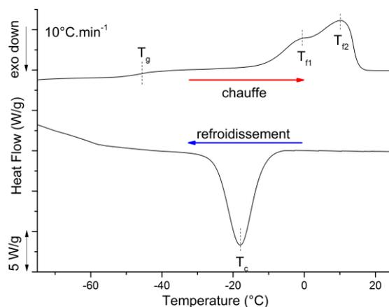
Figure II.8 : Thermogrammes de refroidissement et de chauffe d'un échantillon de THF 100 à 10°C.min<sup>-1</sup>
