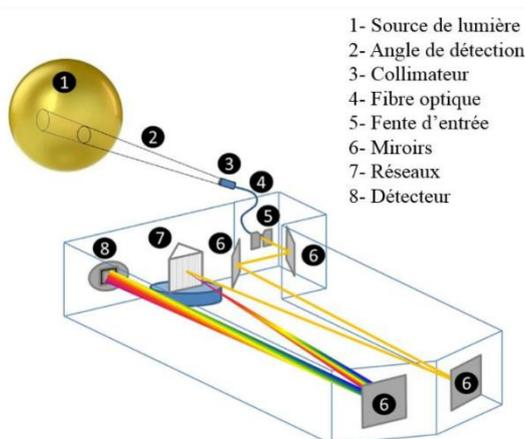
Figure I.64: Structure du monochromateur Jobin-Yvon TRIAX 550 [445].
