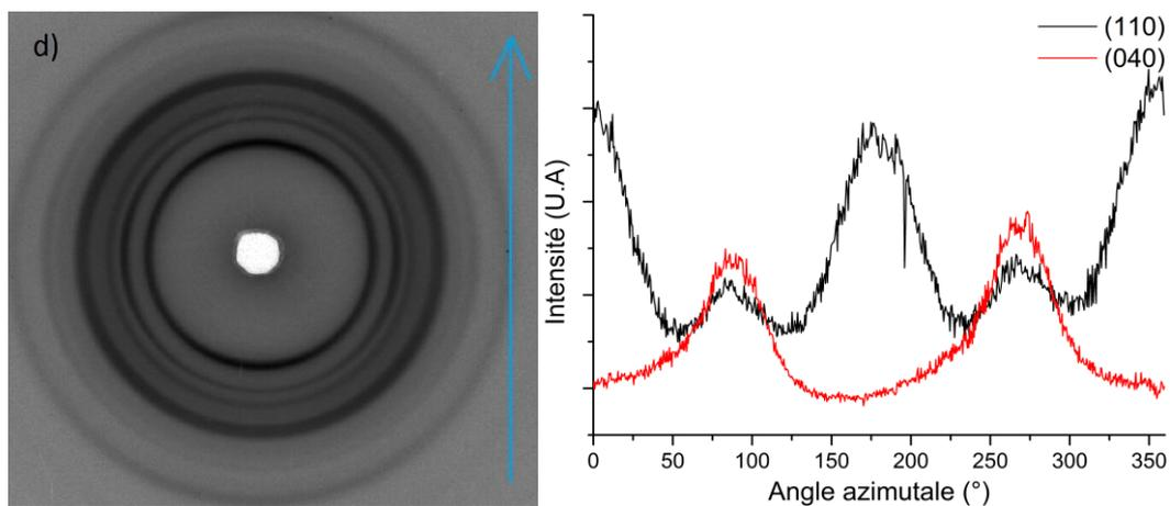
Figure A.47 : Cliché WAXS 2D du CA 100 THF 100 1:1 déformé à  $\epsilon_{33}=0,9$  et profile azimuthale des plans de diffraction (110) et (040) du polypropylène.
