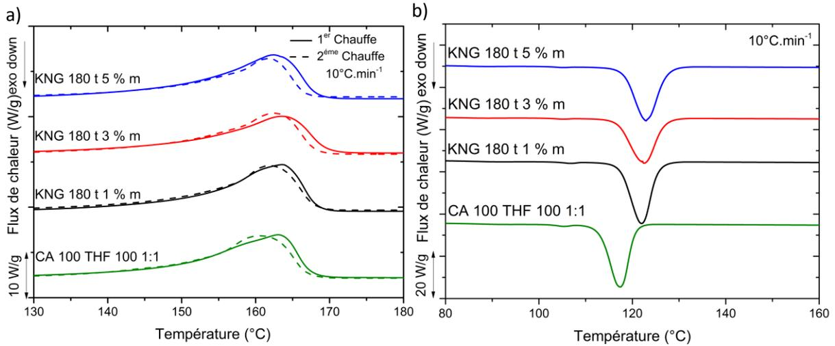
Figure III.60: Thermogrammes de a) fusion et de b) cristallisation des différents nanocomposites chargés KNG 180 traités.
