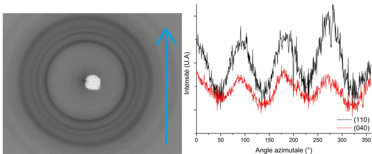
Figure A.34: Cliché WAXS 2D du G3015 THF 100 1:1 et profile azimuthale des plans de diffraction (110) et (040) du polypropylène.
