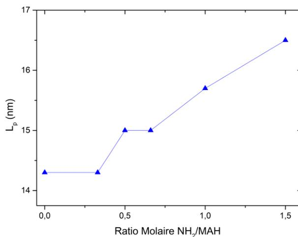
Figure II.17: Evolution de la longue période des matériaux CA 100 + T3000 en fonction du ratio NH<sub>2</sub>:MAH.
