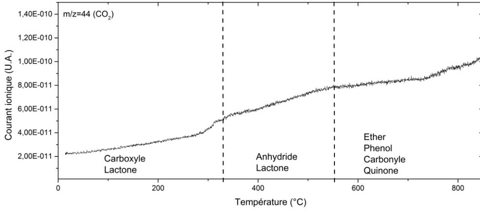
Figure III.21: Evolution de la perte de masse et du spectre de masse  $m/z = 28$  (CO) et  $44$  (CO<sub>2</sub>) de la nano-charge KNG 180 lors des essais ATG sous hélium réalisés à 5 °C.min<sup>-1</sup>.
