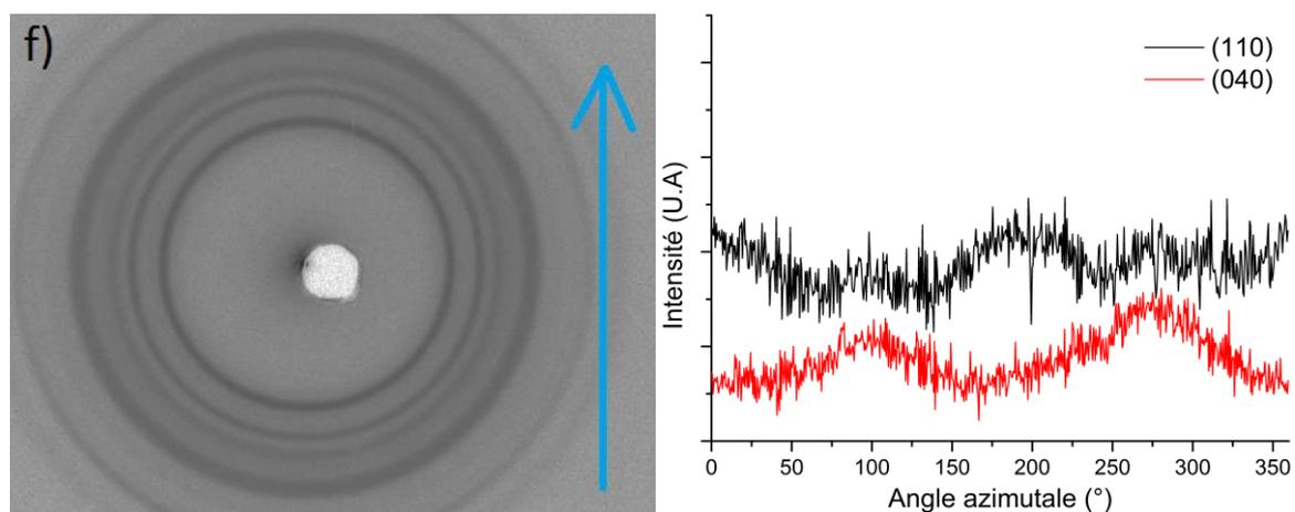
Figure A.40: Cliché WAXS 2D du CA 100 THF 100 1 :1 KNG 180 20%*m* et profile azimutale des plans de diffraction (110) et (040) du polypropylène.
