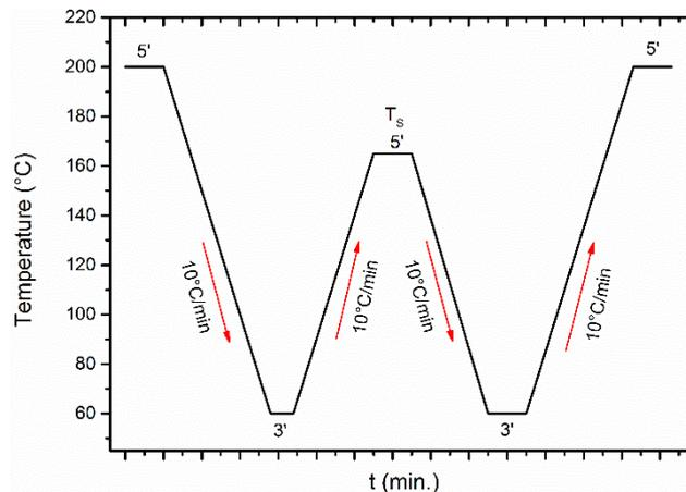
Figure I.53: profil de température d'un cycle du protocole SN [331]
