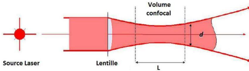
Figure I.59: Schéma du volume analyse par spectroscopie Raman [157].
