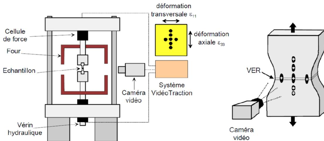
Figure 1.62 : Montage expérimental de la VidéoTraction™ [436]
