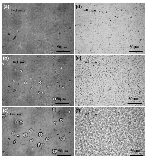
Figure 1.44: Cristallisation isotherme à 130°C d'un iPP vierge (a) à (c), et d'un composite PP/GNP à 0,01 %m. (d) à (f) en fonction du temps (t=0 min, 1 min et 2 min)[336].
