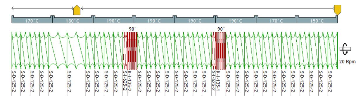
Figure III.32: Profil de vis d'extrusion et de température
