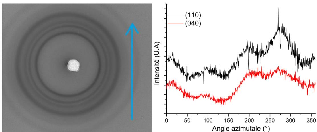
Figure A.25 : Cliché WAXS 2D du CA 100 T3000 1:3 et profile azimutale des plans de diffraction (110) et (040) du polypropylène.
