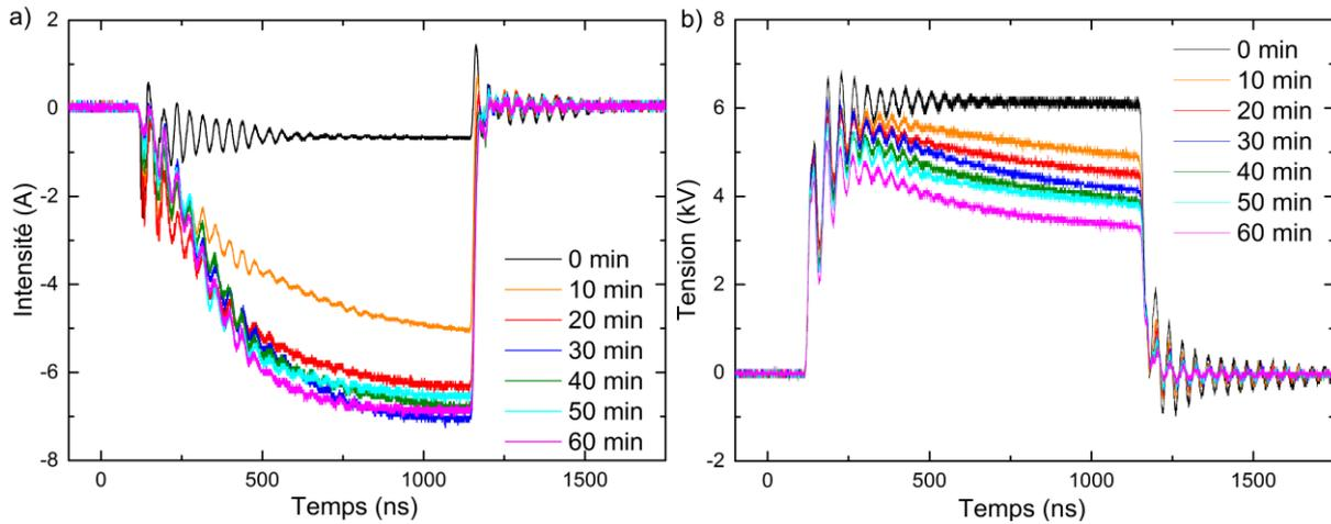
Figure III.9: Evolution a) du courant et b) de la tension appliquée lors de la décharge au fur et à mesure du traitement électrique pour l'élaboration des nanocomposites.
