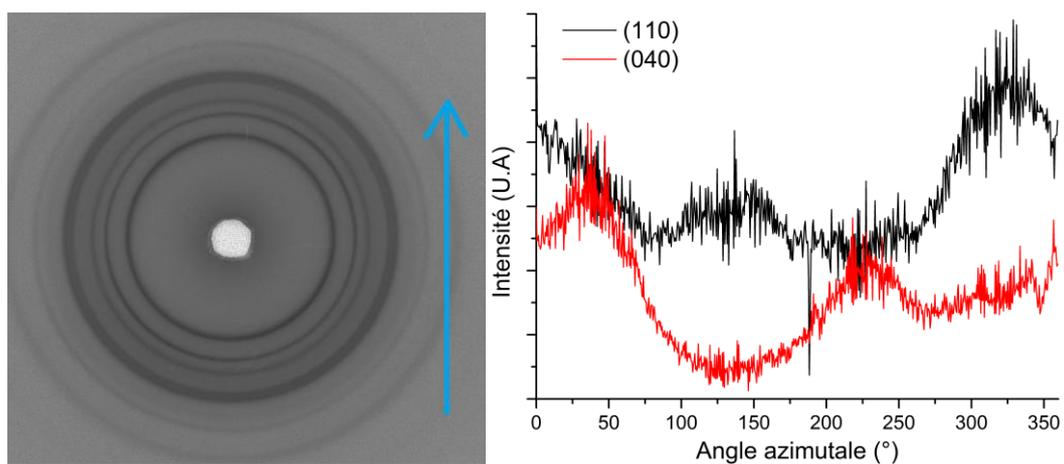
Figure A.29: Cliché WAXS 2D du CA 100 T3000 3:2 et profile azimuthale des plans de diffraction (110) et (040) du polypropylène.
