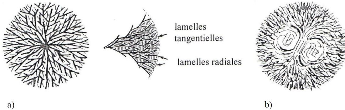
Figure 1.2: Schéma descriptif des deux types de croissance lamellaire au sein des sphérolites de type a)  $\alpha$ , avec une croissance multidirectionnelle, à partir d'un noyau central, et b)  $\beta$ , avec une croissance unidirectionnelle en gerbe [24].
