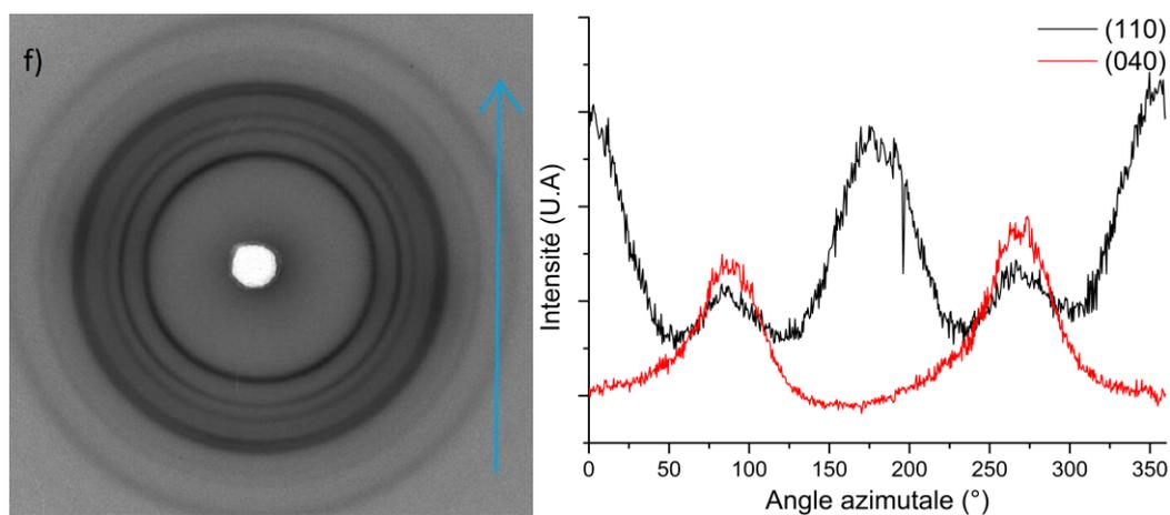
Figure A.49 : Cliché WAXS 2D du CA 100 THF 100 1:1 déformé à  $\epsilon_{33}=1,5$  et profile azimuthale des plans de diffraction (110) et (040) du polypropylène.
