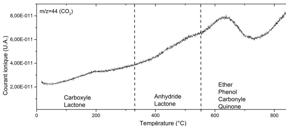
Figure III.22: Evolution de la perte de masse et du spectre de masse  $m/z = 28$  (CO) et  $44$  ( $\text{CO}_2$ ) de la nano-charge KNG 180 traité par plasma lors des essais ATG sous hélium réalisé à  $5\text{ }^\circ\text{C}\cdot\text{min}^{-1}$ .
