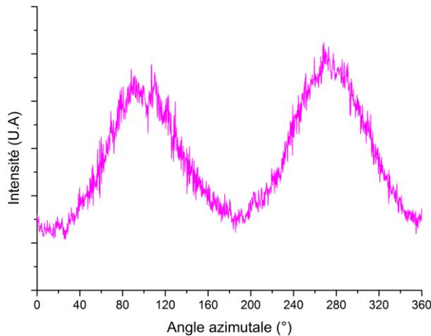
Figure III.34: profil azimutal du plan de diffraction (002) du graphite hexagonal du nanocomposite chargés KNG 180 à 20 %<sub>m</sub>.
