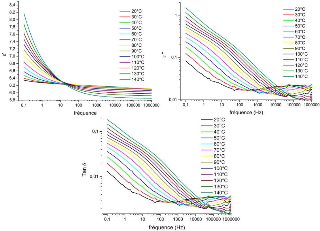
Figure A.61 : Spectre diélectrique  $\epsilon'$ ,  $\epsilon''$ , et  $\text{Tan } \delta$  en fonction de la fréquence du matériau CA 100 THF 100 1:1 KNG 180 3%*m*
