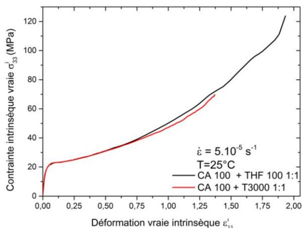
Figure II.52: Comportement intrinsèque des matériaux CA 100 + THF 100 1:1 et CA 100 + T3000 1:1. L'endommagement volumique employé pour le calcul est celui estimé par spectroscopie Raman en partie 2.5.3.3 et 2.5.4.3.
