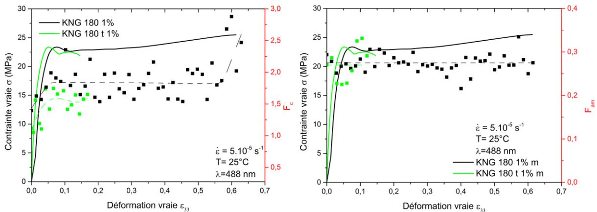
Figure 79: Evolution de l'indice Raman caractérisant l'orientation des chaînes des lamelles cristallines et de la phase amorphe lors de la déformation des nanocomposites chargés de graphite KNG 180 à 1 %m et de graphite KNG 180 traité par plasma
