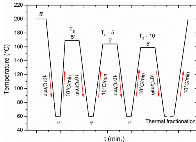
Figure I.56: Profil de température du protocole SSA [331].
