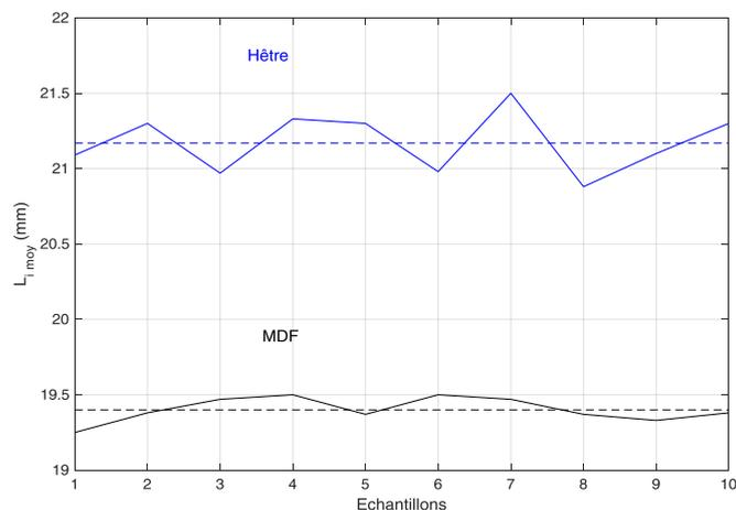
Figure 3.42: Effet matériau en usinage robotisé (configuration flexible)
