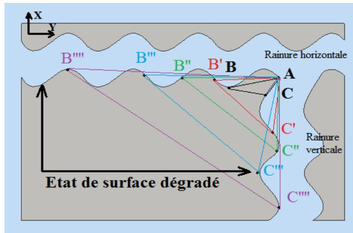
Figure 2.61: Evaluation de l'orthogonalité de l'usinage robotisé
