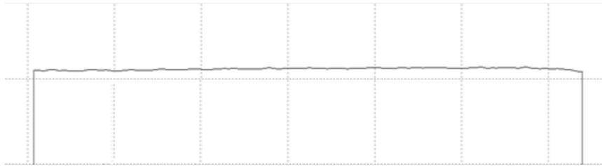
Figure 3.3: Etat de surface de la face latérale de la rainure du polystyrène (scan laser)
