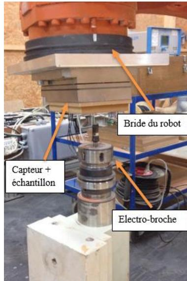
Figure 2.42: Capteur + échantillon sur la bride du robot [15]
