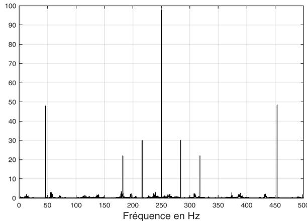
*Figure 3.44.c : FFT des efforts de coupe du Hêtre : Robot flexible*
