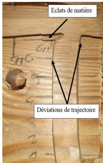
Figure 3.81: Dégradation d'usinage robotisé du mélèze (9000mm/min)
