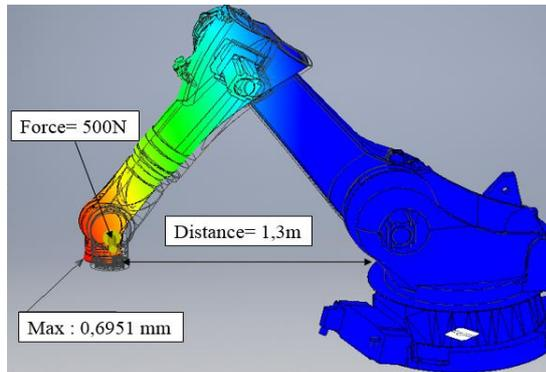
Figure 2.53: Déplacement en configuration rigide
