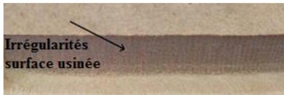
Figure 3.5: Irrégularités d'usinage
