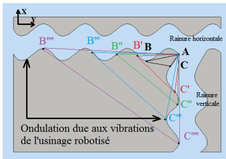
Figure 3.83: Evaluation de l'orthogonalité de l'usinage robotisé
