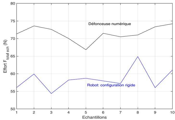
Figure 3.33: Efforts de coupe moyens appliqués par la défonceuse et le robot sur hêtre (configuration rigide)
