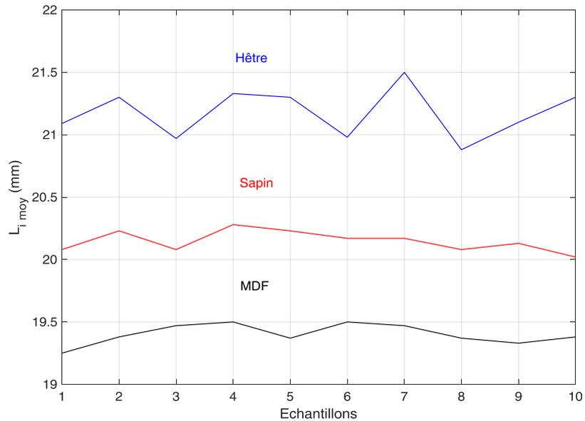
Figure 3.65: Effet matériau sur la qualité dimensionnelle en configuration flexible
