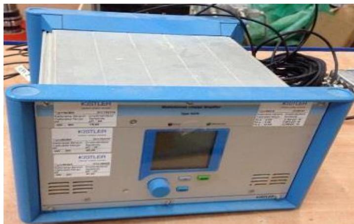
Figure 2.22: Amplificateur de charge[15]
