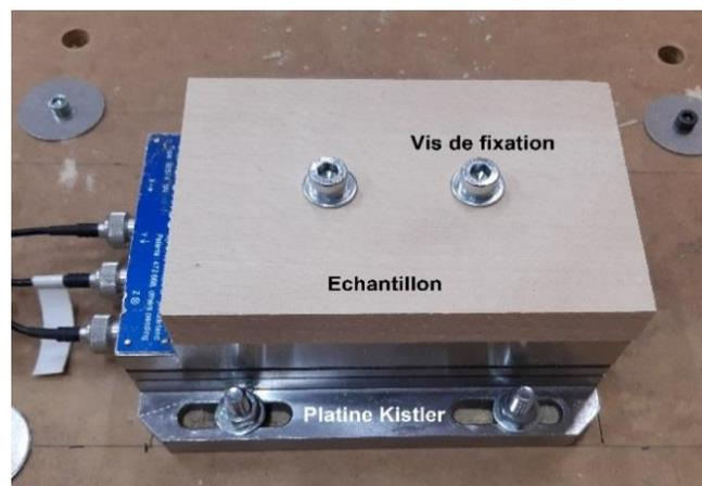
Figure 2.41: Capteur + échantillon sur la table d'usinage[15]
