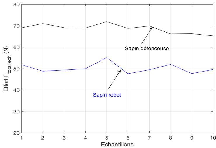
Figure 3.55: Efforts de coupe moyens appliqués sur le sapin par la défonceuse et le robot (configuration rigide)
