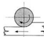
Figure 1.44: Usinage en avalant [46]
