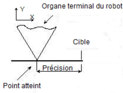
Figure 2.3: Précision d'un robot industriel [Photo personnelle]
