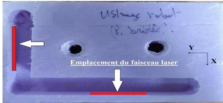
Figure 3.2: Echantillon polystyrène usiné  $V_a=1000$  mm/min /outil 3 arêtes
