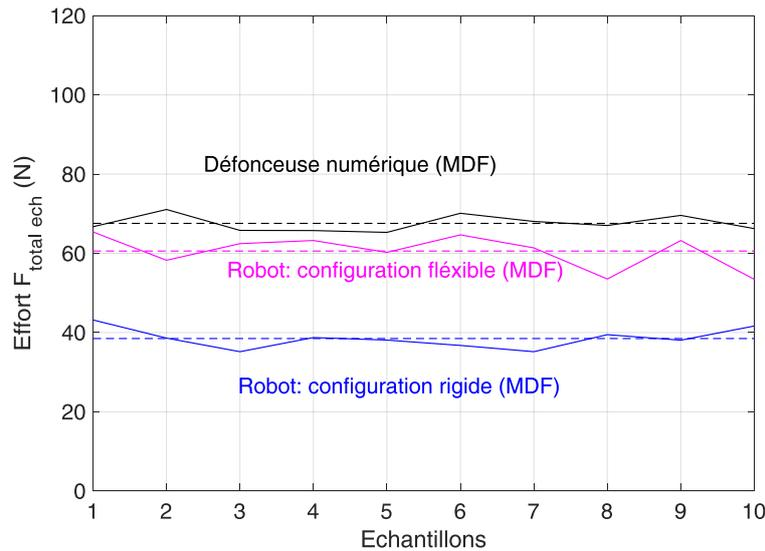
Figure 3.25: Efforts de coupe moyens appliqués par la défonceuse et le robot en configuration rigide et flexible
