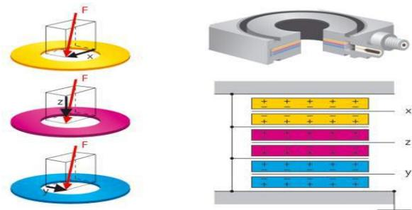
Figure 2.20: 3 paires de plaquettes en quartz [15]
