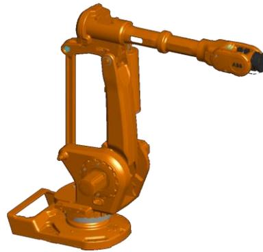
Figure 1.12: Robot sériel à chaîne fermée ABB 6660 [16]
