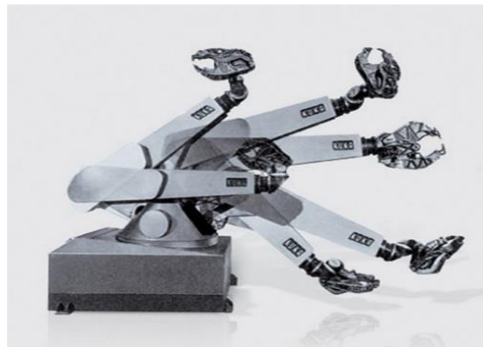
Figure 1.3 : « Famulus » Premier robot industriel polyarticulé 1973 [8]
