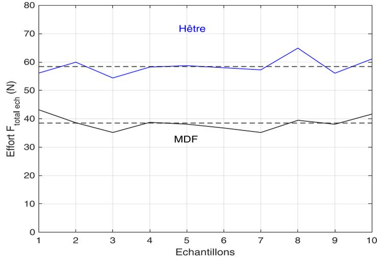
Figure 3.34: Evolution des efforts de coupe de l'usinage du hêtre et MDF en configuration rigide
