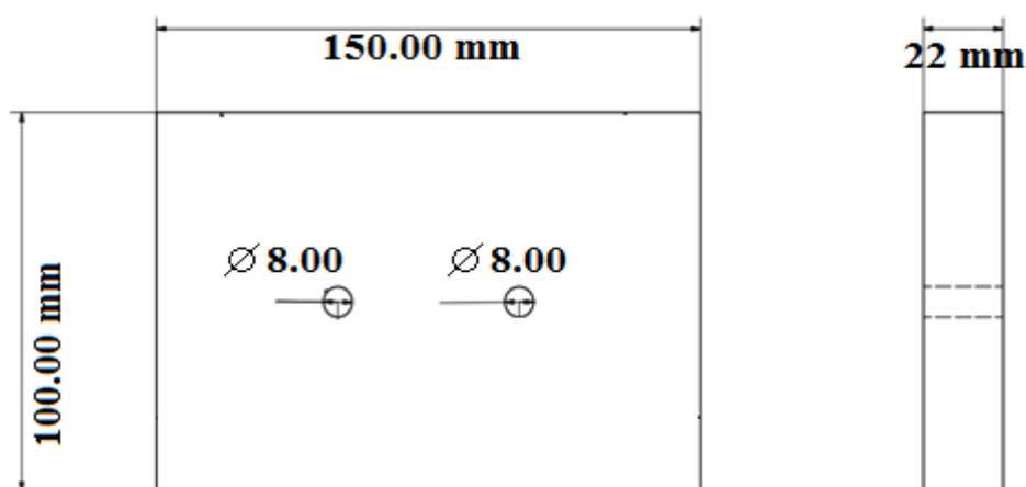
Figure 2.34: Echantillon à usiner
