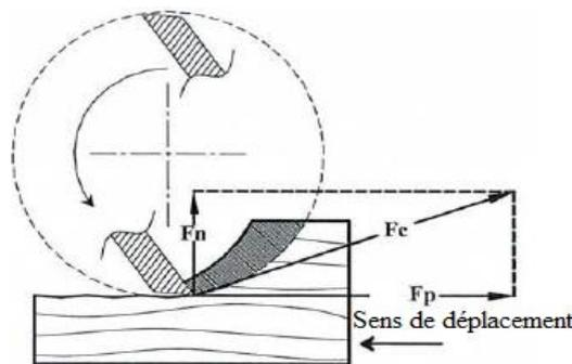
Figure 1.38: Modèle d'efforts parallèles et normaux [48]
