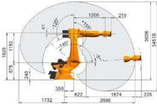
Figure 1.7: Espace de travail d'un robot sériel KUKA [8]
