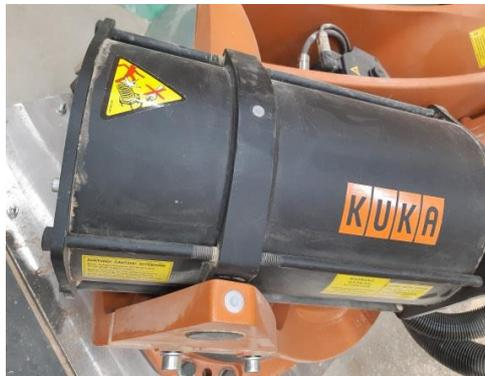
*Figure 2.9: Compensateur de gravité du Kuka kr 210L180 [15]*
