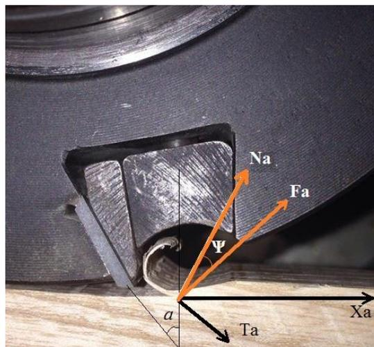
Figure 1.37 : Coupe orthogonale  $0^\circ$ - $90^\circ$  sur une toupie
