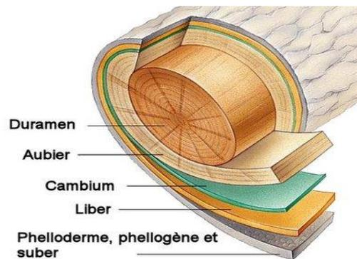
*Figure 1.26: Coupe transversale du tronc d'un arbre [35]*
