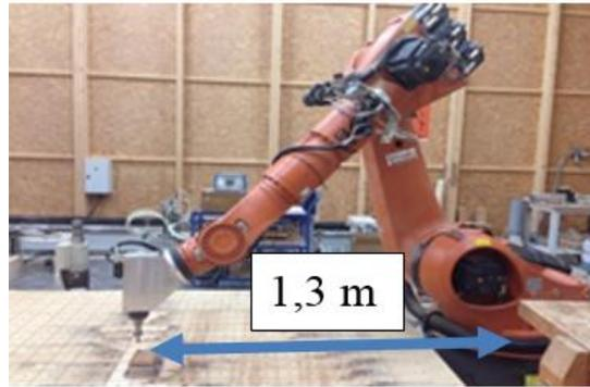
Figure 2.44: Configuration rigide/Pièce bridée[15]
