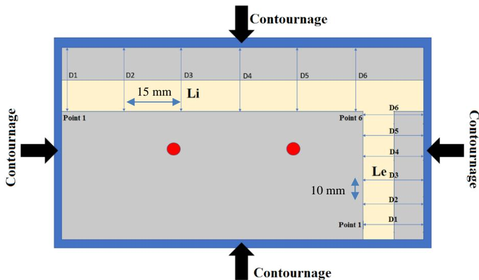
Figure 3.47: Paramètre de mesure de ( $L_e$ )Tableau 3.25: Mesure de la ( $L_e$ )
