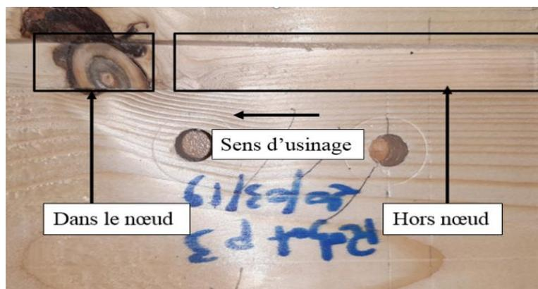
Figure 3.69: Phases d'usinage du Sapin avec nœud
