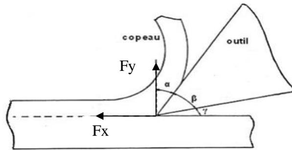
Figure 1.36: Géométrie de la coupe orthogonale[42]
