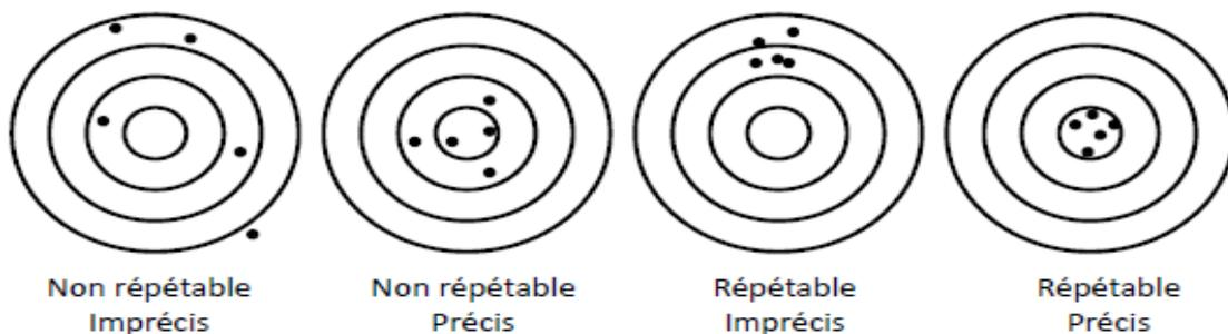
Figure 2.5: Précision et répétabilité du robot [147]
