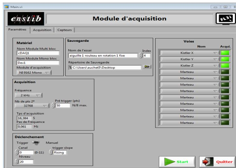
Figure 2.25: Interface de configuration du module [Photo personnelle]
