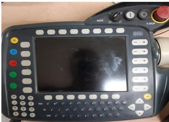
Figure 2.11: Teach Pendant du robot Kuka [15]
