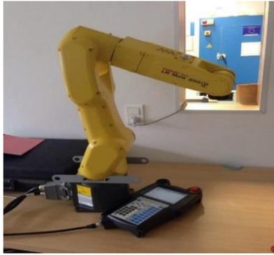
Figure 1.11: Robot sériel à chaîne ouverte Fanuc [15]
