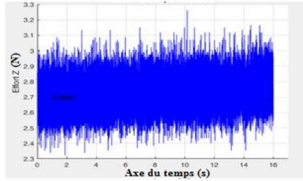
Figure 2.65: Efforts mesurés à vide capteur (axe z)
