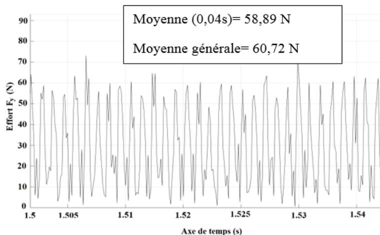
Figure 3.10: Efforts de coupe suivant Y (usinage MOCN)
