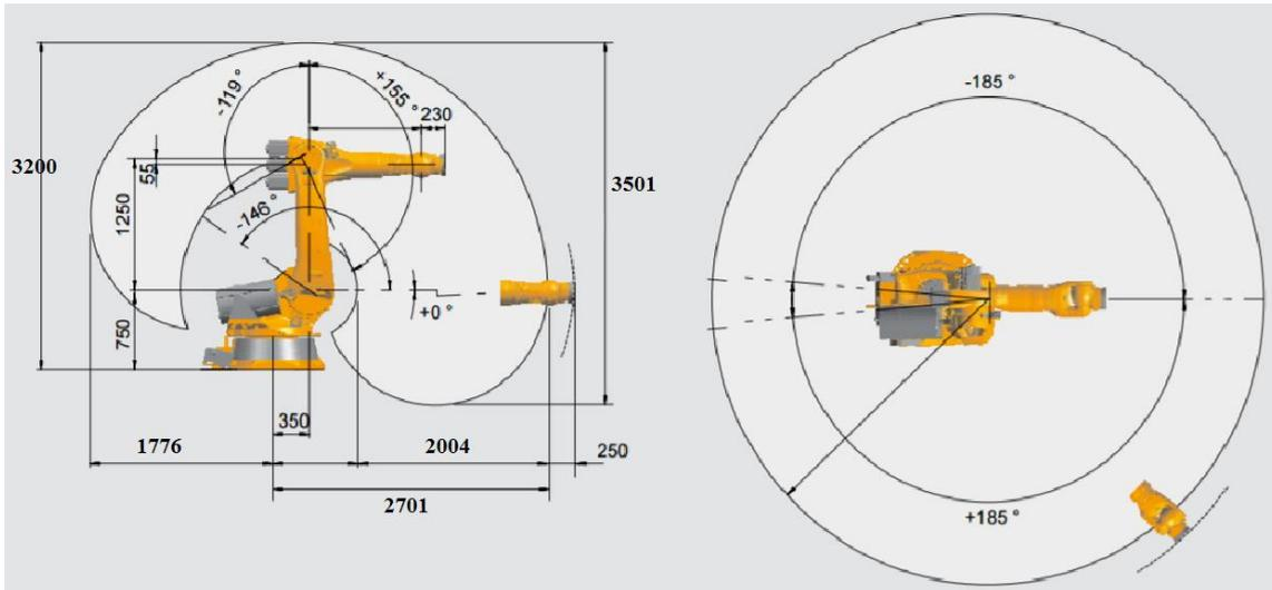
Figure 2.2: Espace de travail du robot Kuka [8]
