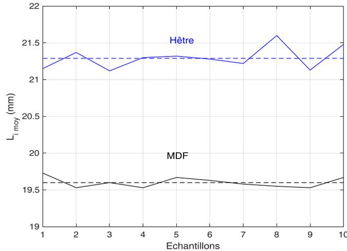
Figure 3.36: Effet matériau en usinage robotisé (configuration rigide)
