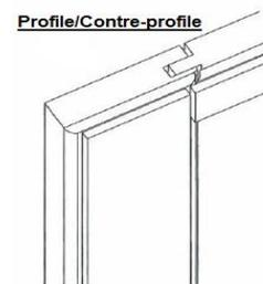
Figure 1.48: Moulure et Rainure [61]
