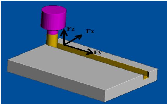
Figure 3.11: Efforts de coupe  $F_x, F_y, F_z$ , rainure suivant Y (mode  $90^\circ-0^\circ$ )
