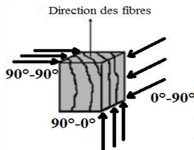
Figure 1.35: Les 3 directions d'usinage du bois [43]
