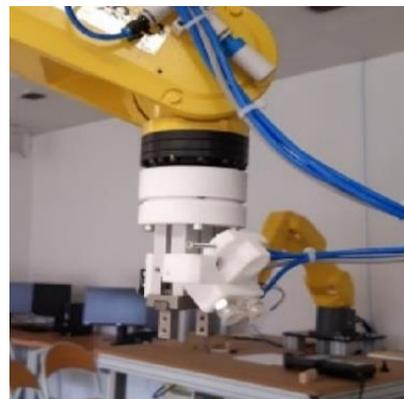
Figure 2.12: Pince + ventouse montées sur un robot Fanuc [15]
