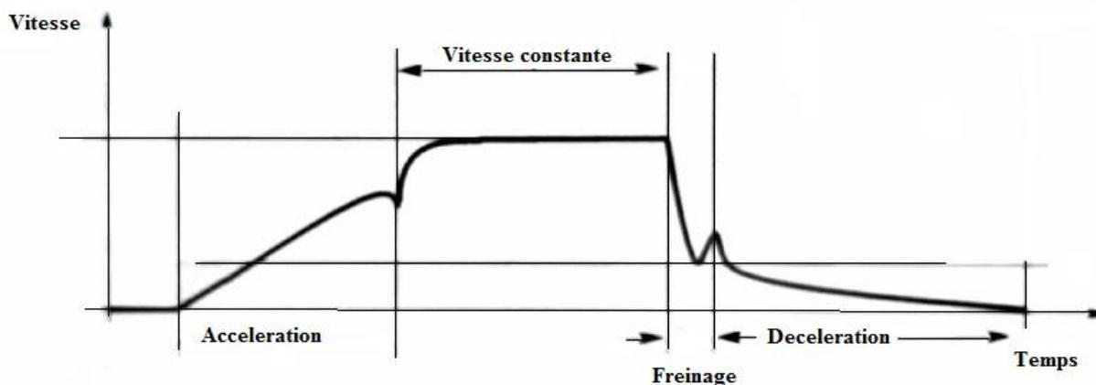
Figure 3.1: Evolution de la vitesse d'un actionneur[8]
