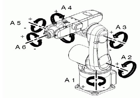
Figure 1.8: Degré de liberté du robot Kuka [8]
