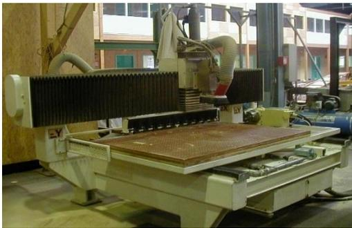
Figure 2.15: La défonceuse numérique [15]
