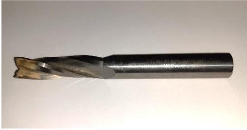
Figure 2.16: Fraise hélicoïdale [15]
