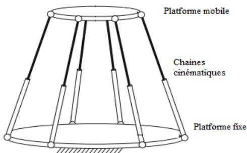
Figure 1.13: Les principaux composants d'un robot parallèle [17].
