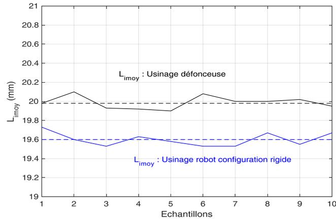
Figure 3.22: Evolution de  $L_{i\_moy}$  avec la défonceuse et le robot en configuration rigide
