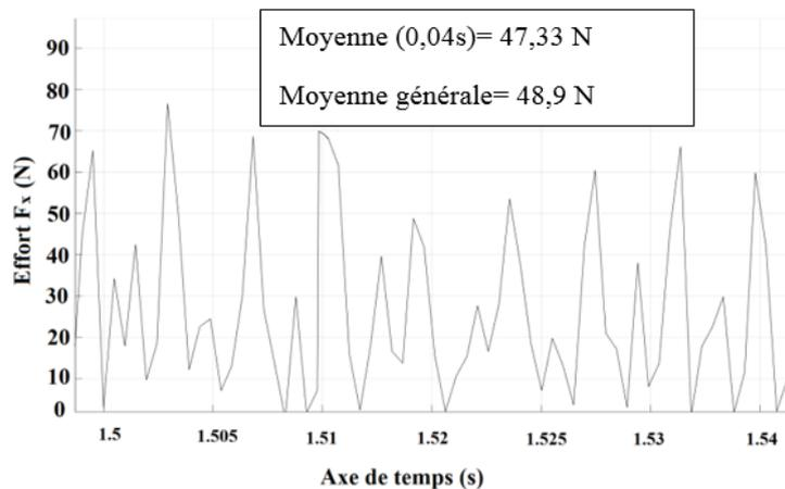
Figure 3.9: Efforts de coupe suivant X (usinage MOCN)
