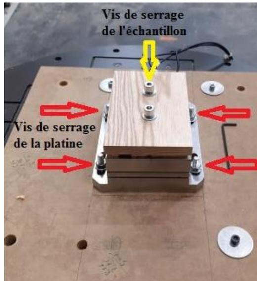
Figure 2.62: Essai à vide platine fixée [15]
