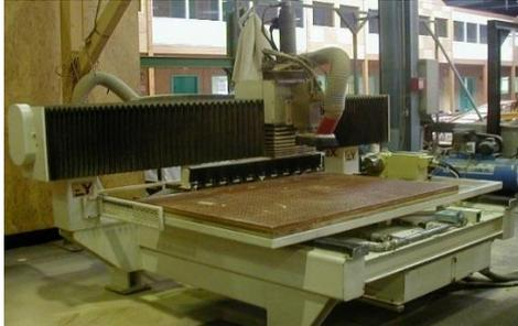
Figure 1.32: Machine à commande numérique CNC [15]
