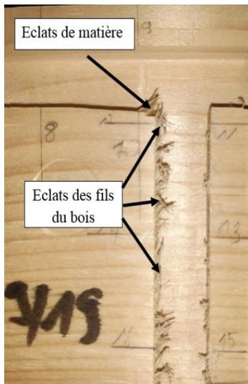
Figure 3.80: Dégradation d'usinage robotisé du Sapin (9000mm/min)
