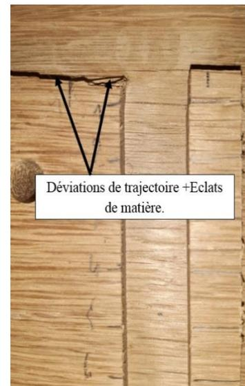
Figure 3.82: Dégradation d'usinage robotisé du chêne (9000 mm/min)
