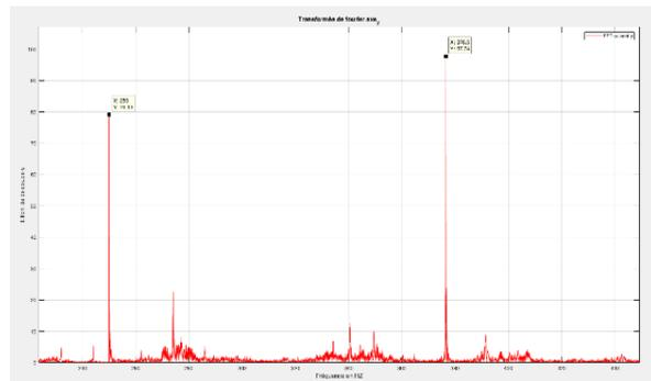
Figure 2.28: Spectre fréquentiel des efforts de coupe
