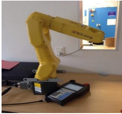
Figure 1.11: Robot sériel à chaîne ouverte Fanuc [15]
