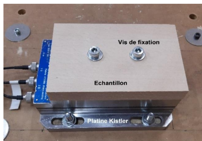
Figure 2.41: Capteur + échantillon sur la table d'usinage[15]
