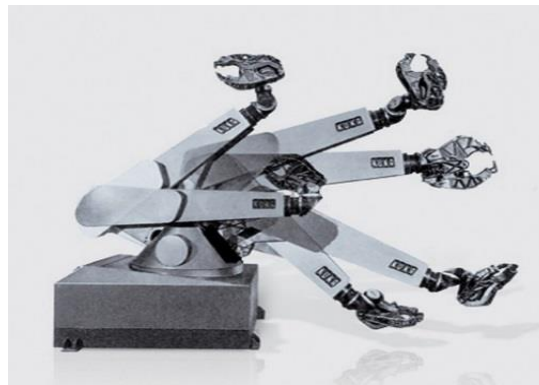
Figure 1.3 : « Famulus » Premier robot industriel polyarticulé 1973 [8]
