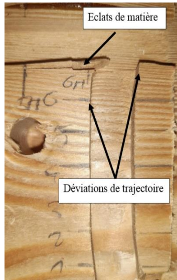
Figure 3.81: Dégradation d'usinage robotisé du mélèze (9000mm/min)
