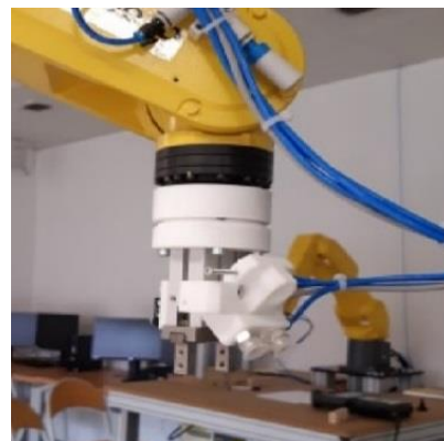
Figure 2.12: Pince + ventouse montées sur un robot Fanuc [15]
