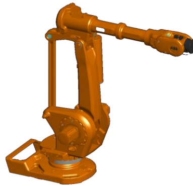
Figure 1.12: Robot sériel à chaîne fermée ABB 6660 [16]
