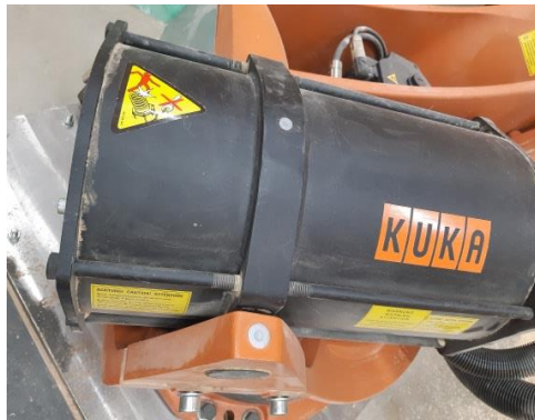
Figure 2.9: Compensateur de gravité du Kuka kr 210L180 [15]
