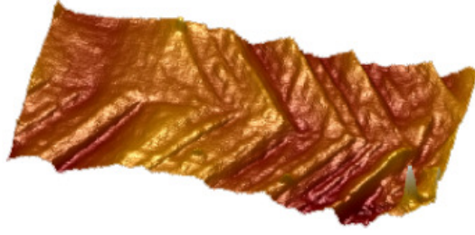
Figure 1.6: Ein Beispiel für eine AFM-Messung an der Oberfläche eines Ni-Bikristalls, der mit der NanoScope-Analyse analysiert wurde (Da Bild wurde zunächst durch Polynomannpassung zweiter Ordnung geflättet, dann mit einem Medianfilter ( 9 \times 9 Matrixoperation) behandelt).
