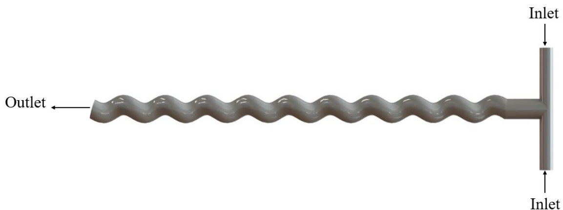
Figure 2: Micro-mélangeur en forme de T avec un design HCHP
