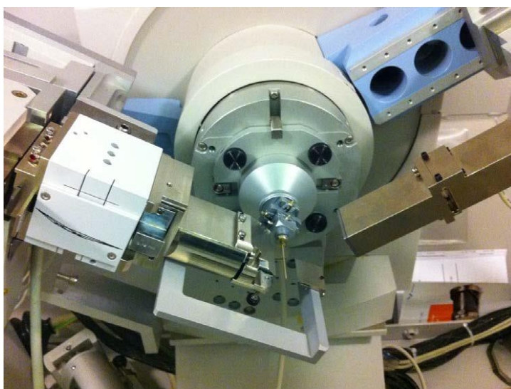
Figure II-12: Diffractomètre à poudres (X'pert PRO PANalytical) du laboratoire CRM2, en mode transmission.
