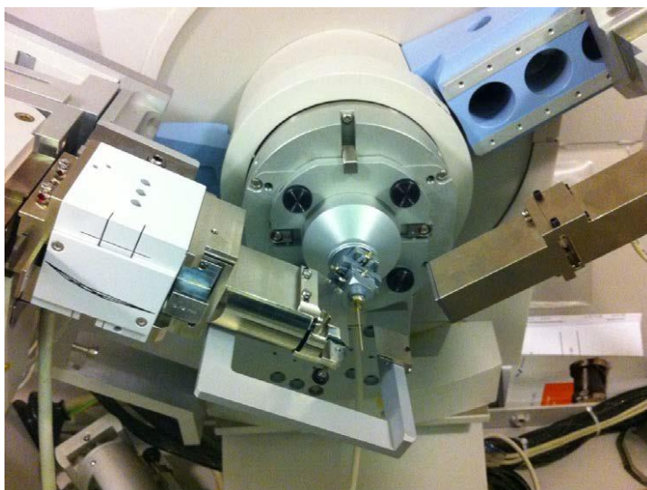
Figure II-12: Diffractomètre à poudres (X'pert PRO PANalytical) du laboratoire CRM2, en mode transmission.
