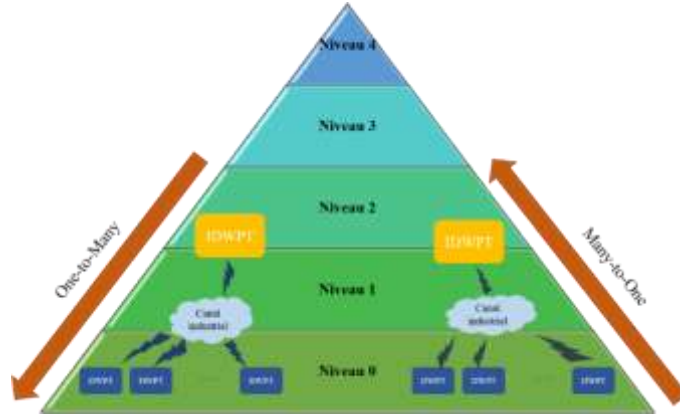
Figure 12 Fonctionnement des modes OtM et MtO dans CIM
