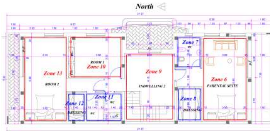
Figure 81 Zonage thermique au niveau du plan 2D du premier étage
