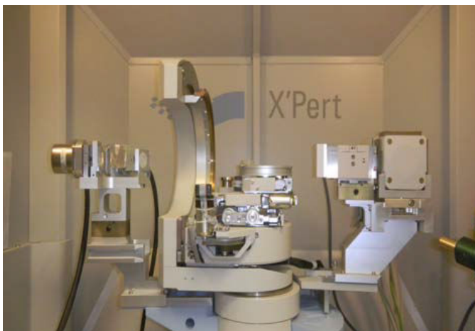
Figure A.10 : a) DRX à haute résolution b) Schéma de la mesure par diffraction à rayon X
