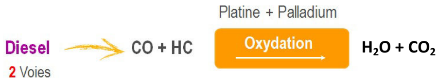
Figure 1.8 : Principe de fonctionnement d'un catalyseur DOC
