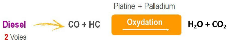
**Figure 1.8 : Principe de fonctionnement d’un catalyseur DOC**
