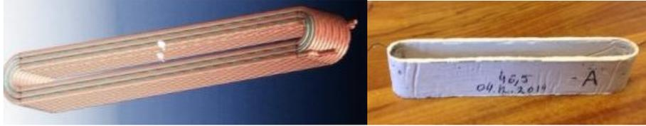
Figure II.2. Forme des bobines inorganiques préfabriquées.
