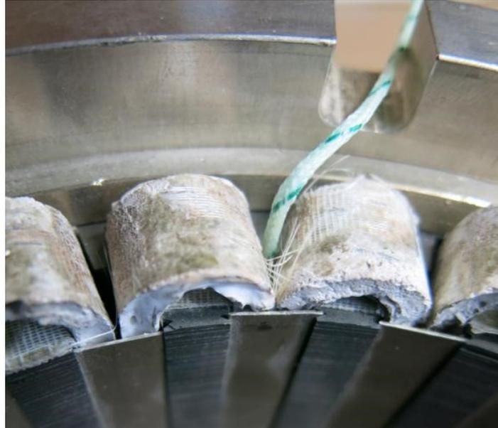
Figure IV.40. Position du thermocouple assurant la mesure de  $T_B$ .
