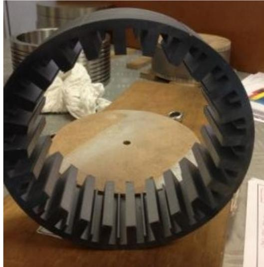
Figure IV.1. Photographie du circuit magnétique du stator.
