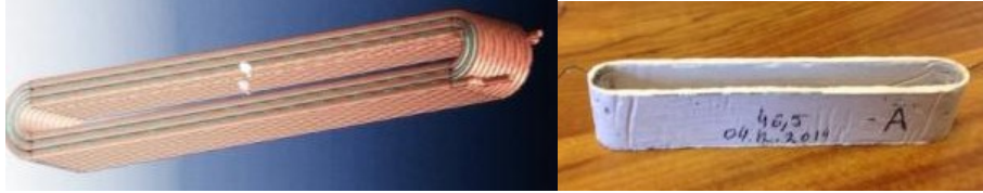
Figure II.2. Forme des bobines inorganiques préfabriquées.
