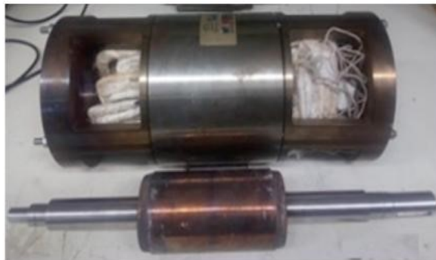
Figure I.5. Vue générale du moteur à induction HT° [9].
