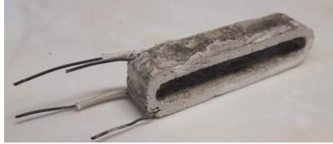
Figure III.11 Bobine spécifique utilisée pour mesurer la capacité inter-spires.
