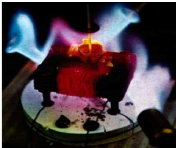
Moteur électrique à 700°C, fil argent-palladium, plaquage Ni, isolation NiO Brevet General Electric, New-York, USA, 1971
