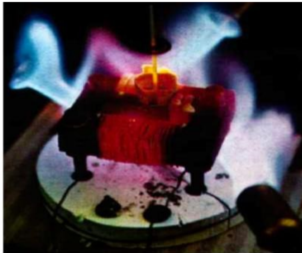
Moteur électrique à 700°C, fil argent-palladium, plaquage Ni, isolation NiO Brevet General Electric, New-York, USA, 1971
