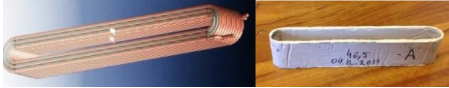
Figure II.2. Forme des bobines inorganiques préfabriquées.
