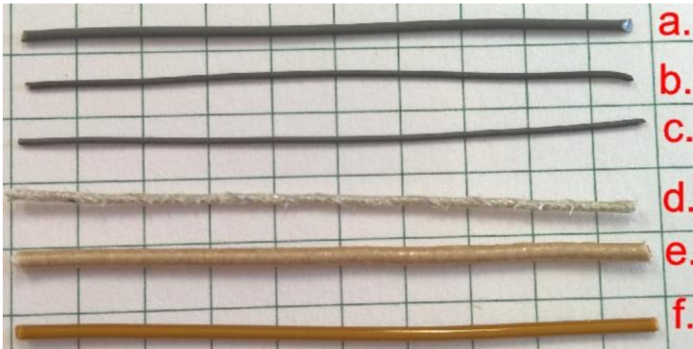
Figure I.14. Différents types des fils hautes températures [10].
