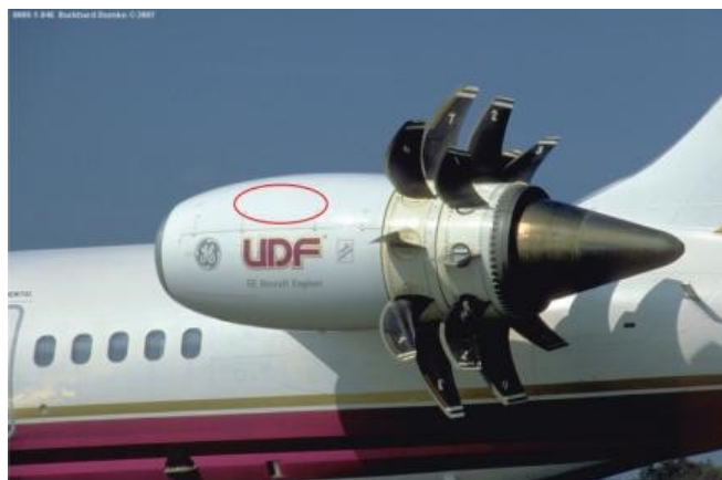
Figure I.1. Nacelle « open rotor » contenant un générateur proche de la turbine, en ambiance chaude [2].
