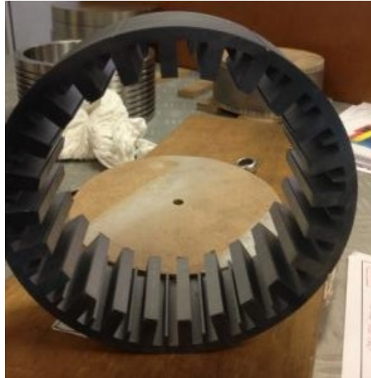
Figure IV.1. Photographie du circuit magnétique du stator.
