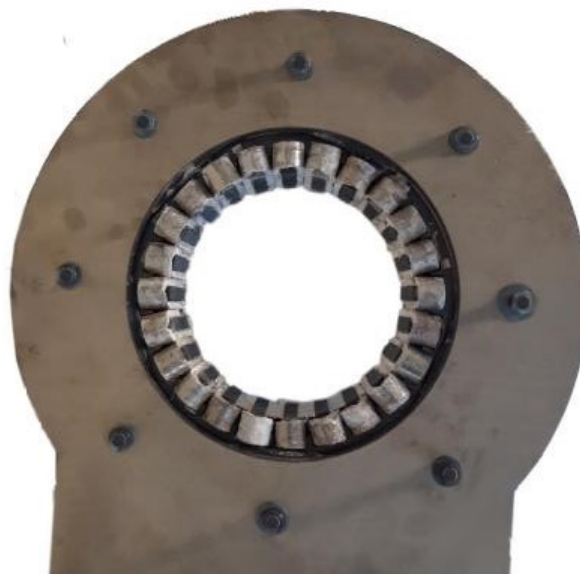
Figure IV.2. Empilement magnétique maintenu par des flasques provisoires dans le but d'ajuster les bobines au fur et à mesure de leur construction.
