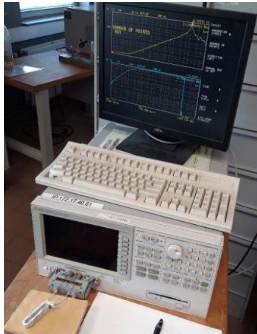
Figure III.9 Dispositif de mesure de l'impédance d'une bobine dans l'air (vue générale).
