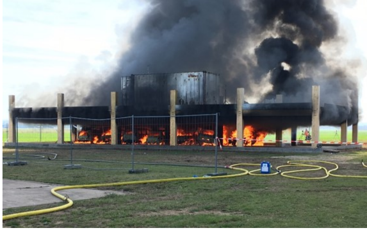
FIGURE 1 – Photo de l'essai parking bois-béton mené par Arbonis et le CSTB en 2017.
