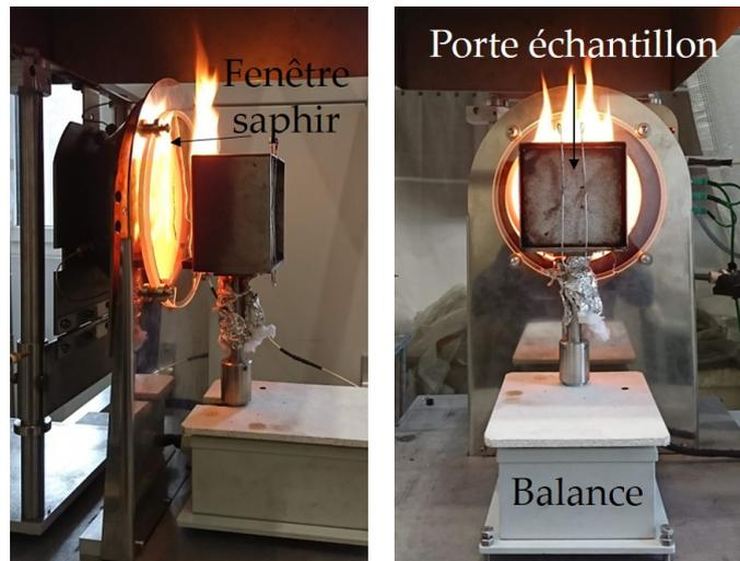
FIGURE 2.9 – Photo d'un échantillon enflammé avec la présence de la fenêtre saphir entre l'échantillon et le cône.
