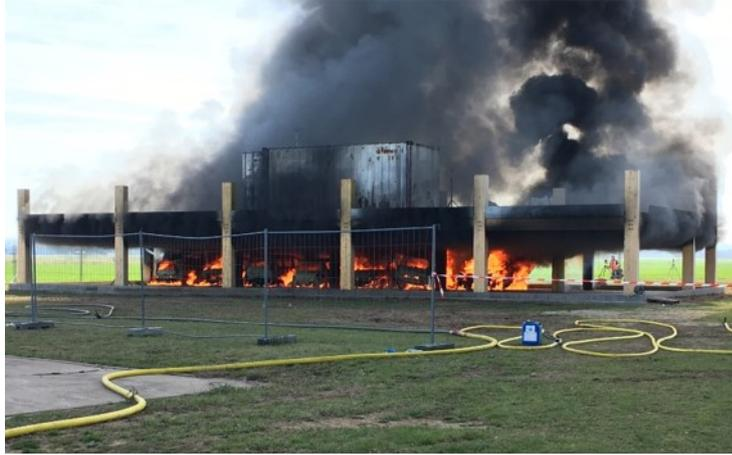
FIGURE 1 – Photo de l'essai parking bois-béton mené par Arbonis et le CSTB en 2017.
