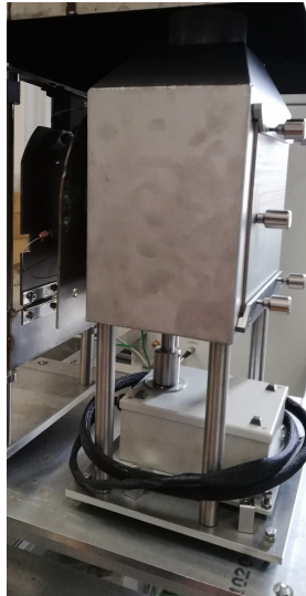
FIGURE 2.10 – Photo de l’enceinte à atmosphère contrôlée placée devant le cône.
