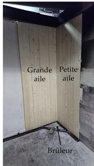
FIGURE 2.12 – Photo d'une éprouvette disposée sur le SBI. La grande et la petite aile sont de la même dimension.
