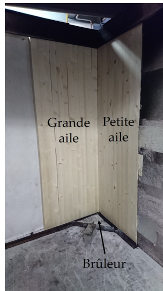
FIGURE 2.12 – Photo d'une éprouvette disposée sur le SBI. La grande et la petite aile sont de la même dimension.
