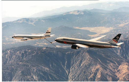
FIGURE 1.7 – Essais en vol de certification aux conditions givrantes.
