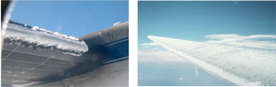
FIGURE 1.1 – Gauche : accrétion de glace sur le bord d'attaque d'une aile ( d_g < 50 \mu\text{m} ), à droite : accrétion de glace sur l'extrados d'une aile (SLD) (Sources : NASA et UCAR)
