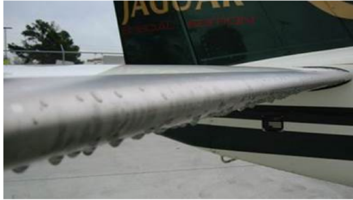
FIGURE 1.3 – Injection de fluide dégivrant sur le bord d'attaque d'une aile d'avion
