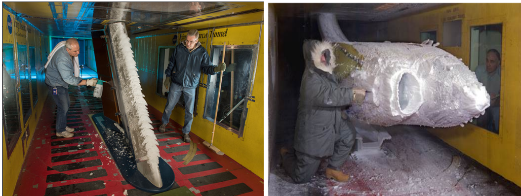
FIGURE 1.5 – Photographies de l'intérieur de la soufflerie de la Nasa Glenn Research Center. L'image de gauche représente un essai d'accrétion de givre sur le bord d'attaque d'une aile d'avion et celle de droite un essai réalisé sur une maquette d'avion.
