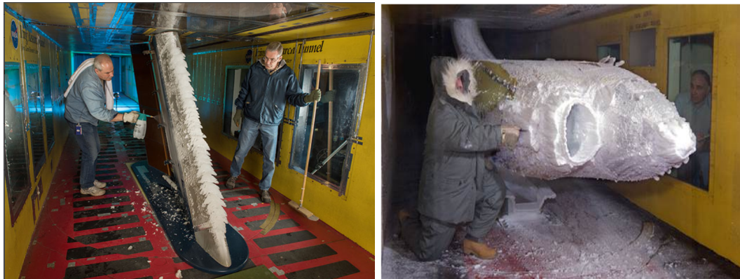
FIGURE 1.5 – Photographies de l'intérieur de la soufflerie de la Nasa Glenn Research Center. L'image de gauche représente un essai d'accrétion de givre sur le bord d'attaque d'une aile d'avion et celle de droite un essai réalisé sur une maquette d'avion.
