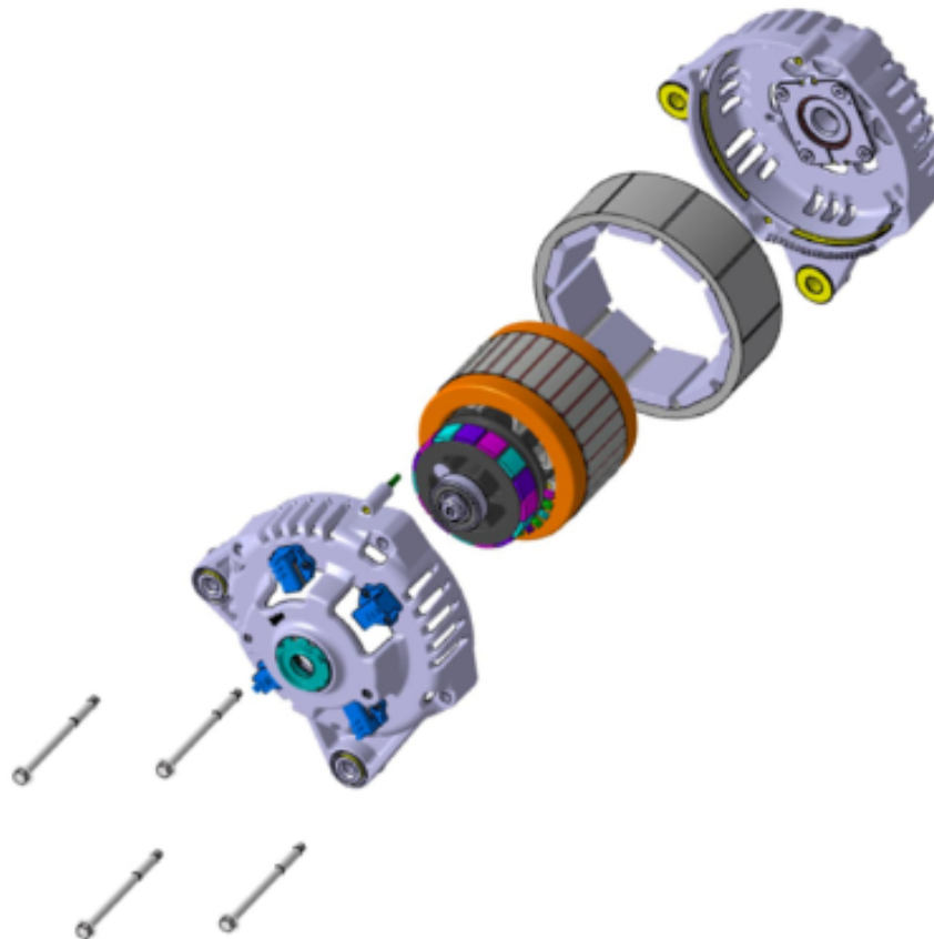
FIGURE 4.28 – Vue CAO éclatée du prototype à aimants permanents [Dev19]
