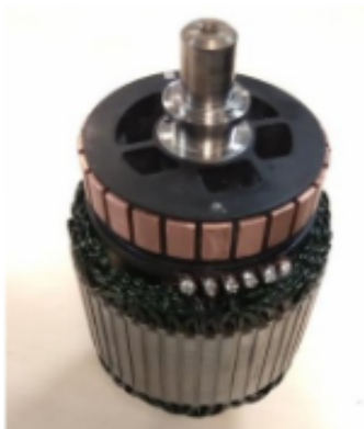
FIGURE 4.29 – Photo de l'ensemble induit – collecteur du prototype à aimants
