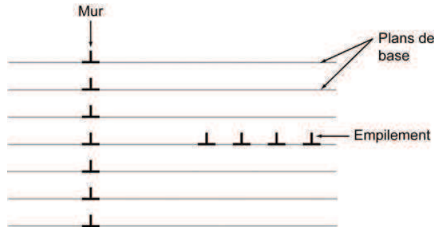
Figure I.9 – Schéma 2D d'un mur de dislocations et d'un empilement.
