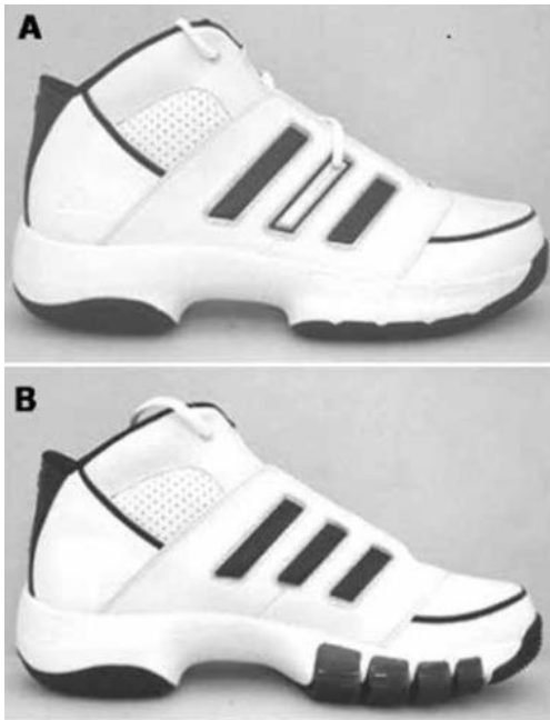
Figure 13 : La photo A représente la chaussure de basketball classique. La photo B représente la même chaussure équipée des éléments de compression au niveau médial de l'avant du pied. Ainsi, lors d'un appui sur cette zone (e.g. un changement de direction), la compression médiale de la semelle place le pied en pronation et limite donc l'inversion de la cheville (d'après Fleischmann et al., 2013).
