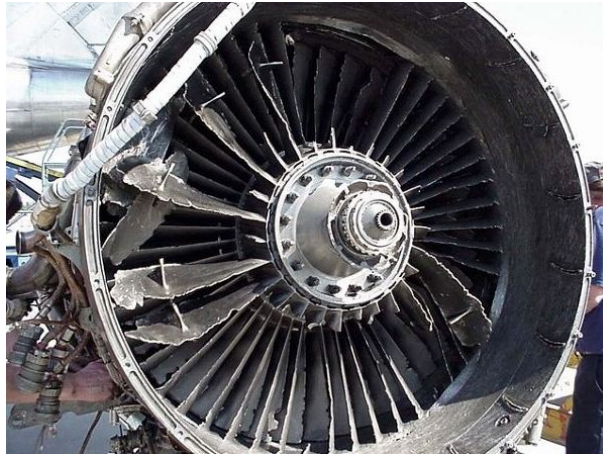
FIGURE 1.5 – Turbomoteur endommagé suite à l'impact d'une bernache du canada [Johnson 2010]
