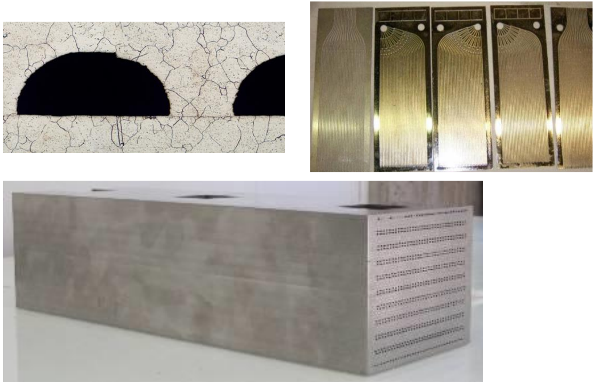
Figure I - 1. Vaporeformeur du projet Loki-R : canaux brasés (haut gauche), plaques milli-structurées (haut droite), reformeur brasé (bas).
