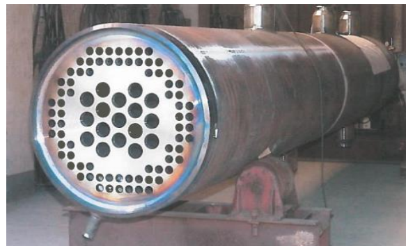
Figure I - 3. Exemple de WHB : installé sur site (à gauche) et arrangement spatial interne des tubes (à droite). (Brochure Process Gas Cooler Alstom).
