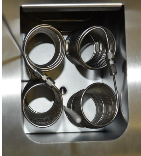
Figure II - 24. Arrangement des spires dans la cuve du bain thermostaté Julabo ME-6.
