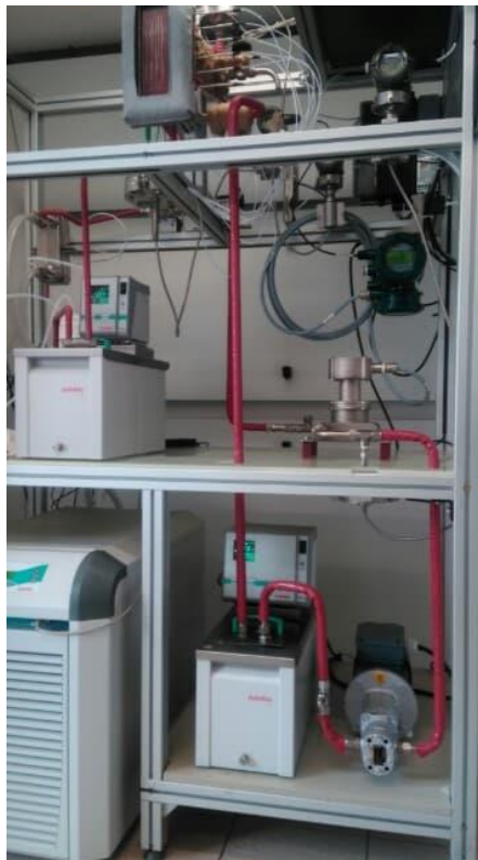
Figure V - 36. Photo du circuit d'huile du banc de test.
