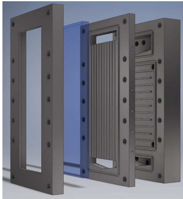
Figure II - 12. Vue explosée du vaporiseur d'étude, de gauche à droite : le couvercle de maintien, la vitre de visualisation, la plaque milli-structurée et le bloc multi-tâche.
