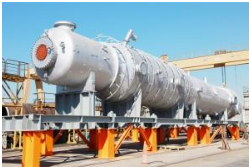
Figure I - 2. Exemple de taille d'un bouilleur à chaleur perdue de taille standard.
