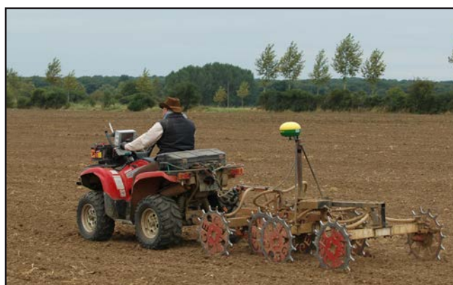
Figure 62 : mise en œuvre de la méthode électrique tractée (dispositif ARP de Géocarta) à Senon en 2010 (cliché : J.-C. Sztuka)
