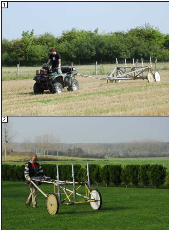
Figure 67 : mise en œuvre de la méthode magnétique tractée (dispositif AMP de Géocarta) à Amel en 2011 (1) et de la méthode magnétique manuelle à Senon en 2012 (2) (clichés : J.-C. Szuka)
