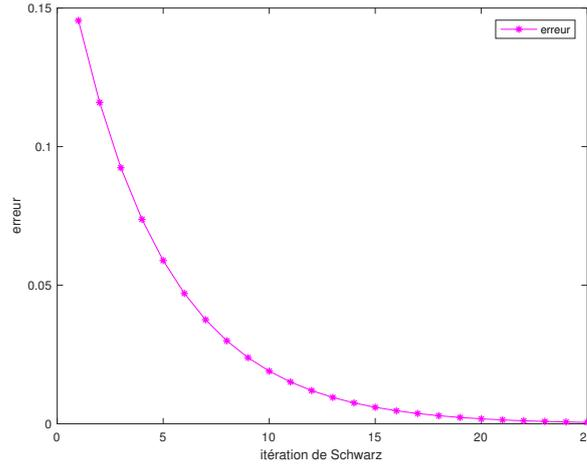
FIGURE 3.17 – Evolution de l’erreur en norme  $L^2 \|u_h^n - u\|_2$  dans le cas du problème (3.73)
