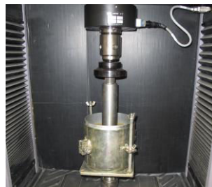
Figure 2. 8 : Essai de poinçonnement.
