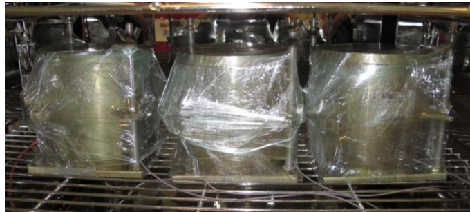
Figure 3. 1 : Eprouvettes isolées et placées dans l'enceinte climatique.
