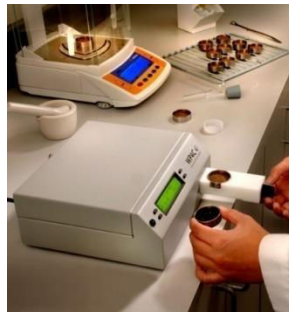
Figure 2. 14 : Mesure de la succion avec le potentiomètre.
