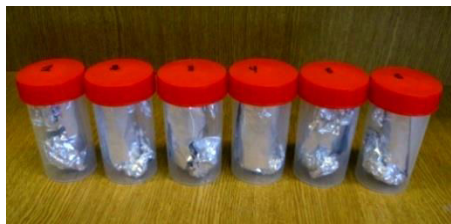
Figure 2. 10 : Éprouvettes isolées dans des boites hermétiques.
