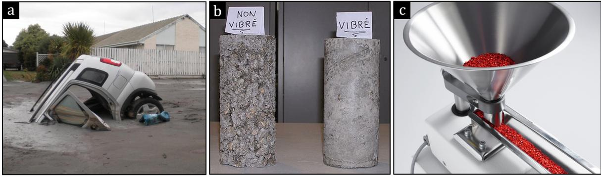
**Figure 2.7** Exemples de l'effet des vibrations sur les milieux granulaires : (a) Liquéfaction des sols lors d'un séisme, (b) Homogénéisation et compaction du béton par vibration et (c) Trémie d'alimentation vibrée pour contrôler le débit de particules.
